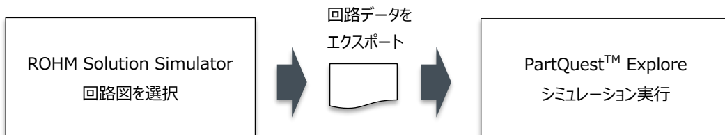
Figure1. ROHM Solution Simulator の回路データを PartQuest™ Explore へエクスポートしシミュレーションを実行する
