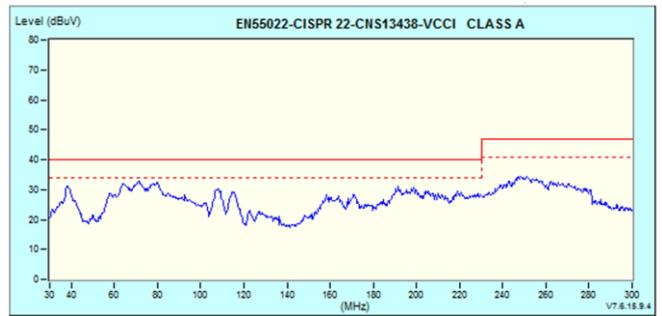
Figure 21. 放射ノイズ測定結果 (RE)
