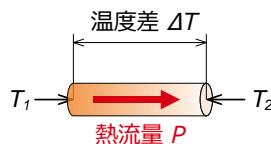
$$\text{熱抵抗 } R_{th} = \frac{T_1 - T_2}{\text{熱流量 } P} = \frac{\text{温度差 } \Delta T}{\text{熱流量 } P} \quad [\text{°C/W}]$$
