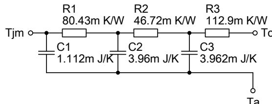
Figure 5. 热モデルの一例、Cauer 型 RC 热回路網
