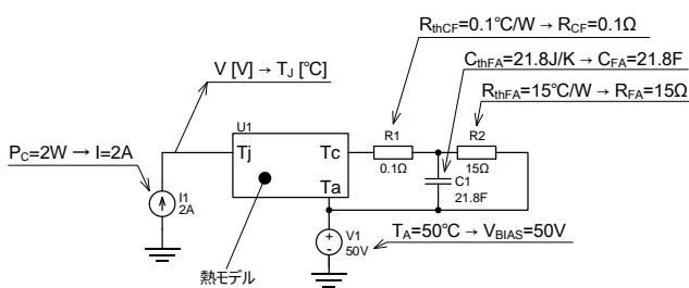
Figure 3. シミュレーション回路の一例
