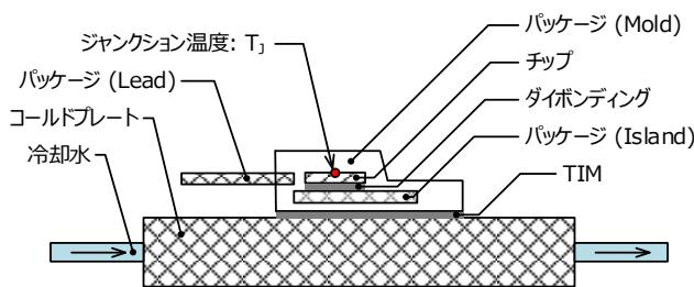
Figure 8. 測定実装図の一例
