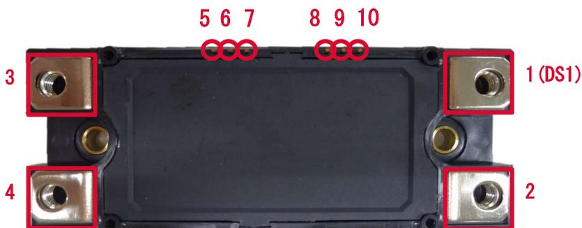
Figure 16. フル SiC モジュールの各端子位置（上面）
