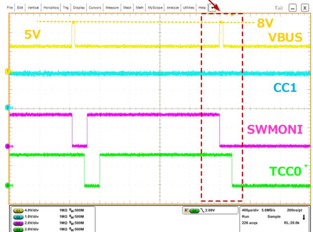
Figure 16. 27μs の過電圧パルス印可による OVP 状態のラッチ
