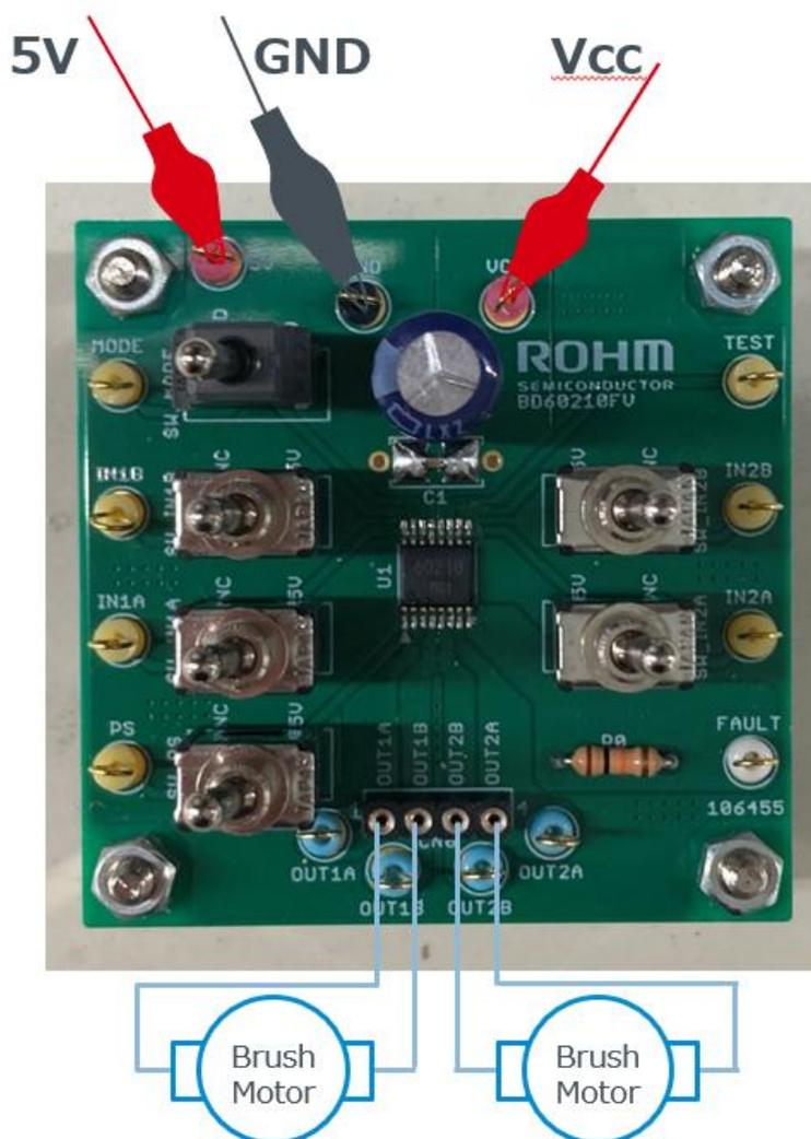
Figure 5. 評価ボードの配線例
