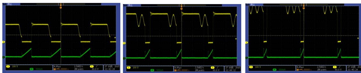
Figure 2-5. ドレイン電圧/電流波形 (VO=24V, IO=1.0A, PO=24W)
