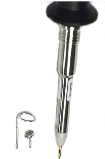
Figure 10. 作成した簡易プローブ・チップ・アダプタ
