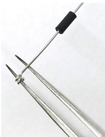
Figure 9. アダプタのチップ（先端）支持部分を作成
