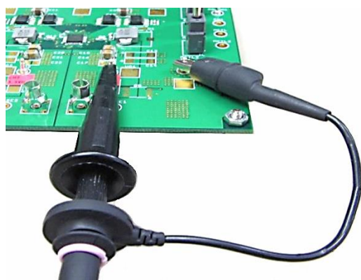
Figure 1. 電圧プローブによるスイッチング箇所のモニタ、グラウンド側は付属のワニ口グラウンドリードで接続
