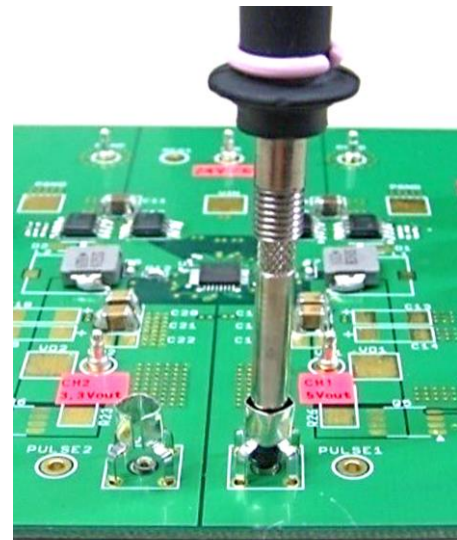
Figure 6. プローブ・チップ・アダプタを使用しスイッチング箇所をモニタした状態
