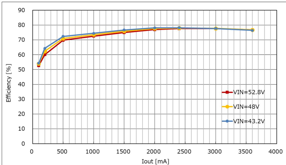
Figure 11. 電力変換効率 vs 負荷電流
