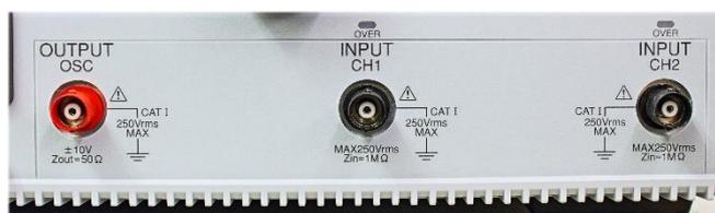
Figure 5 各端子は筐体と端子間が電氣的に絶縁されている
