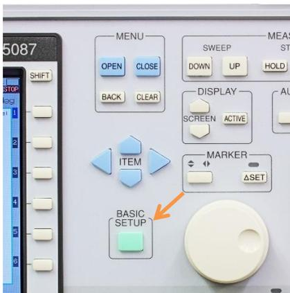
Figure 8 BASIC SETUP キー
