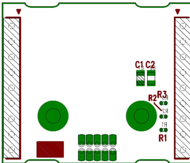
図 3-2. 基板シルク図 (裏面)
