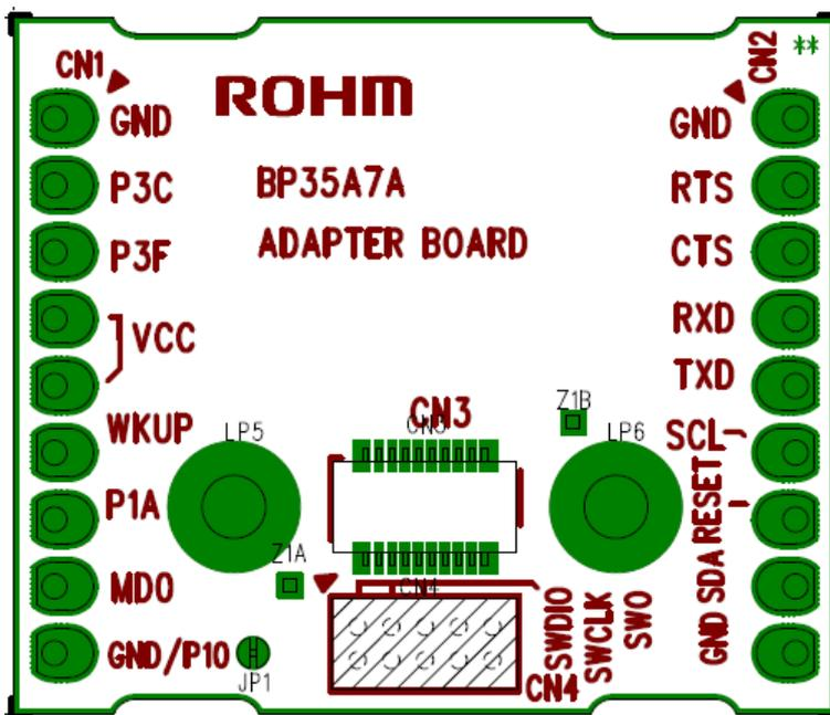
図 3-1. 基板シルク図 (表面)
