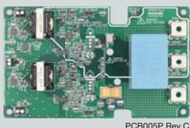
SiCデバイスを容易に評価していただくためのソリューション評価ボード
