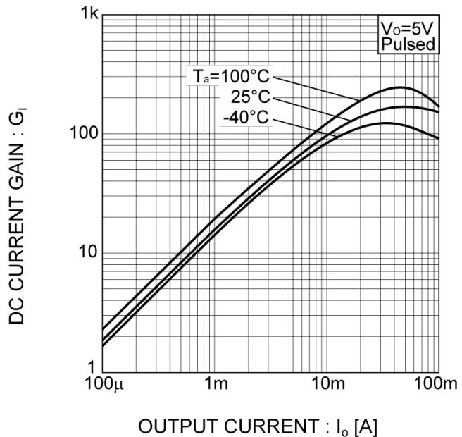
●電氣的特性曲線( $T_a=25^{\circ}\text{C}$ )
