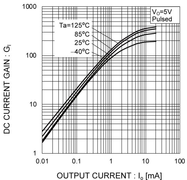
●電氣的特性曲線( $T_a=25^{\circ}\text{C}$ )
