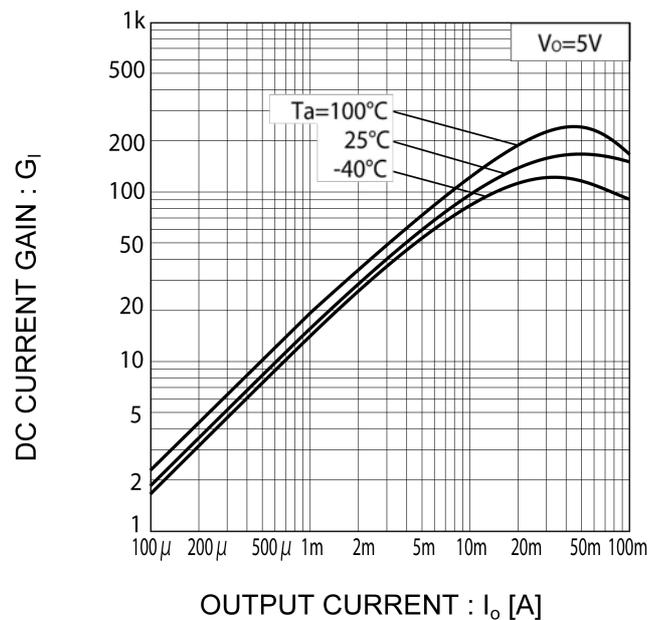
●電气的特性曲线 ( $T_a=25^\circ\text{C}$ )
