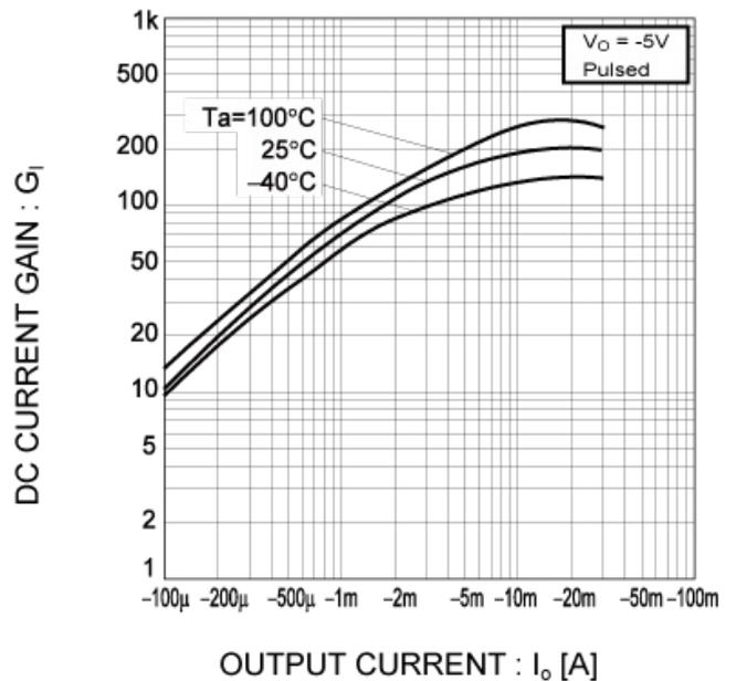
●電気的特性曲線 ( $T_a=25^\circ\text{C}$ )
