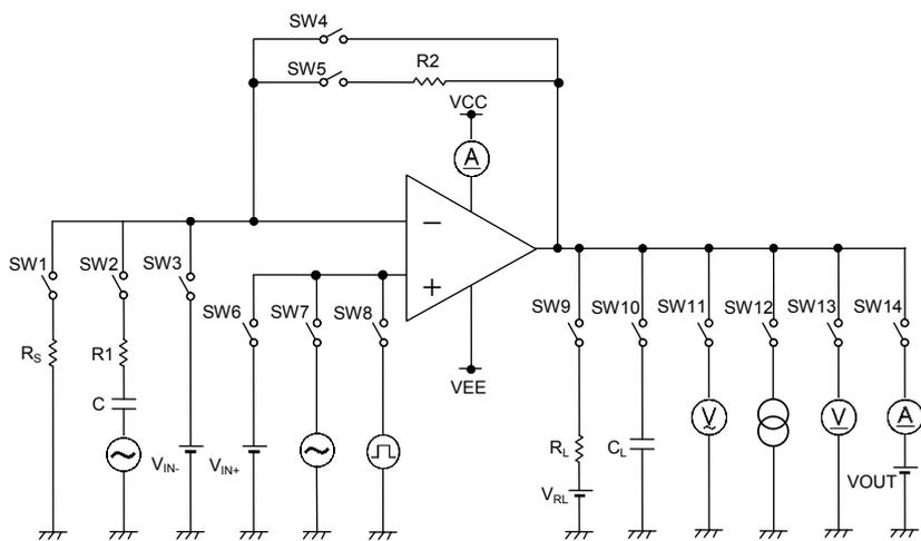
Figure 69. 測定回路 2 (片チャンネルのみ)
