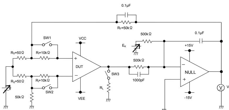
Figure 68. 測定回路 1 (1 チャンネルのみ)
