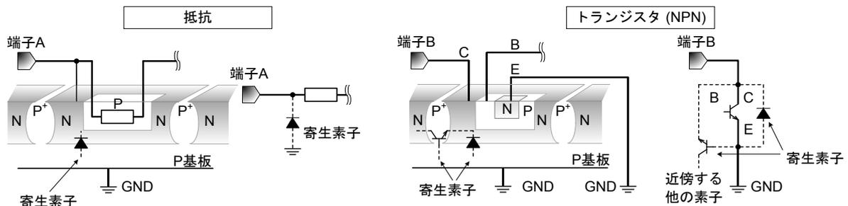
Figure 77. モノリシック IC 構造例
