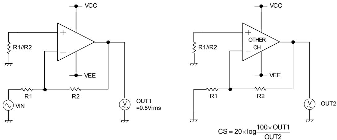
Figure 71. 測定回路 3 (チャンネルセパレーション)
