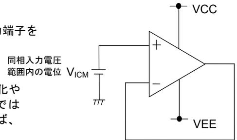
Figure 78. 未使用回路処理例
