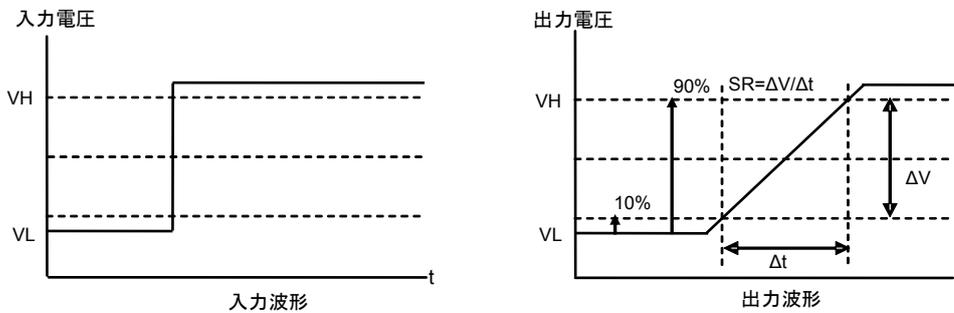
Figure 50. スルーレート測定時 入出力波形
