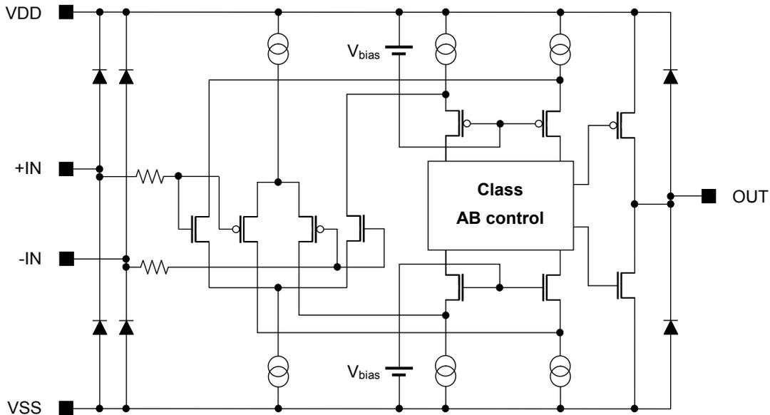
Figure 1. 内部等価回路図(1チャンネルのみ)
