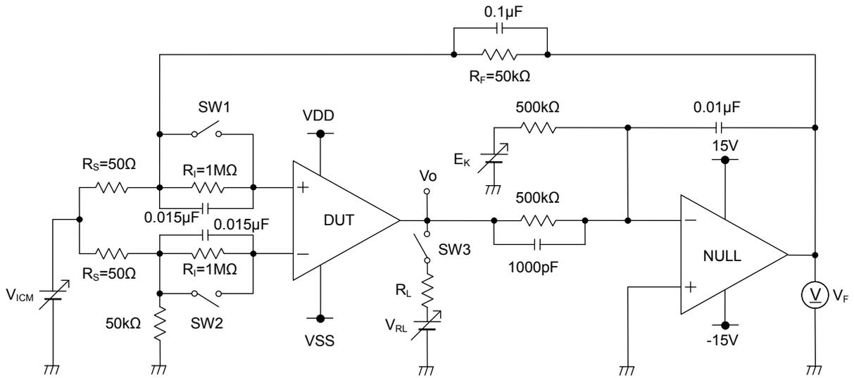
Figure 48. 測定回路(1チャンネルのみ)
