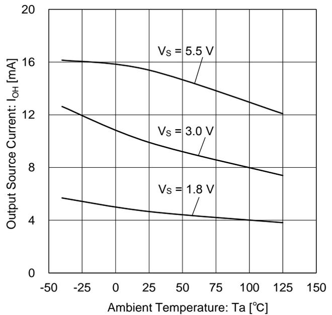
Figure 8. 出力ソース電流 vs 温度
