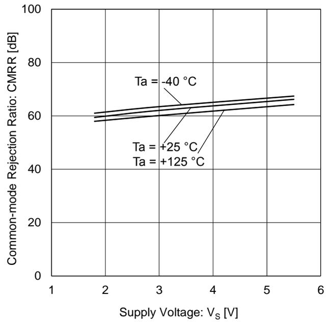
Figure 18. 同相信号除去比 vs 電源電圧
