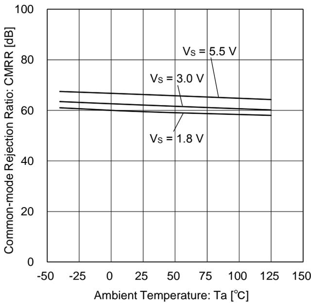
Figure 19. 同相信号除去比 vs 温度
