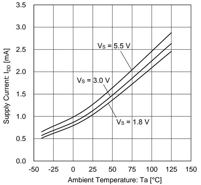
Figure 2. 回路電流 vs 温度
