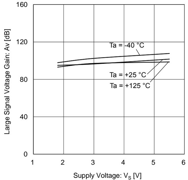
Figure 16. 大振幅電圧利得 vs 電源電圧
