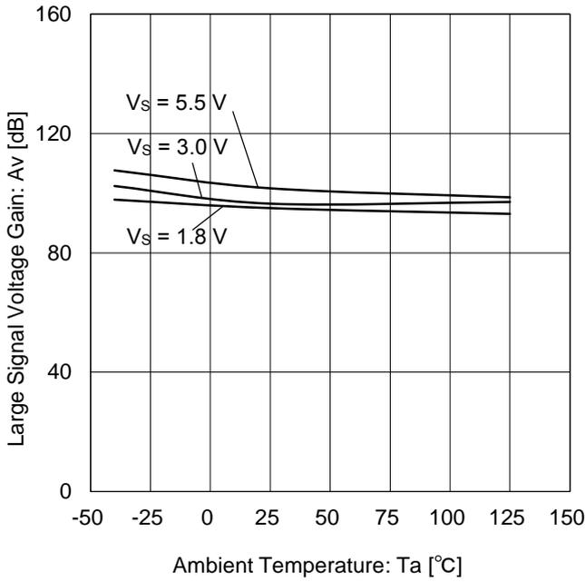
Figure 17. 大振幅電圧利得 vs 温度
