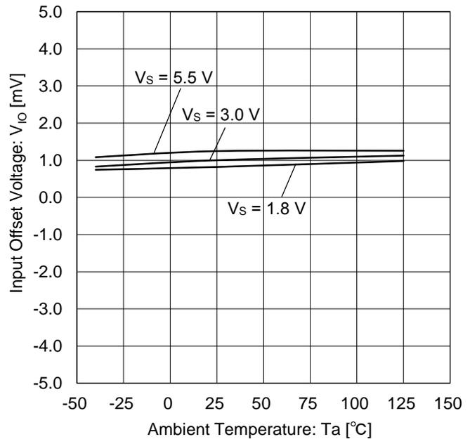
Figure 12. 入力オフセット電圧 vs 温度
