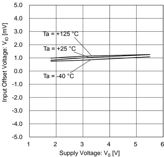
Figure 11. 入力オフセット電圧 vs 電源電圧
