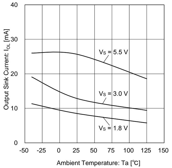
Figure 10. 出力シンク電流 vs 温度
