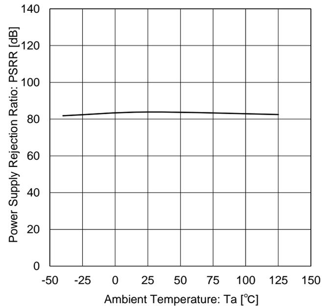
Figure 20. 電源電圧除去比 vs 温度
