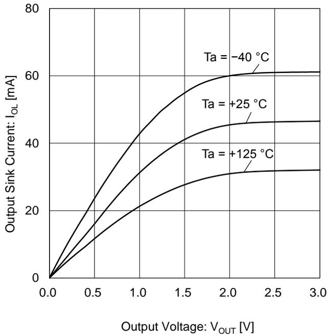
Figure 9. 出力シンク電流 vs 出力電圧
