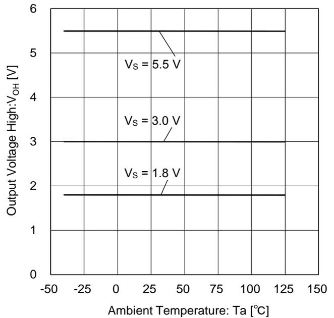
Figure 4. 出力電圧 High vs 温度
