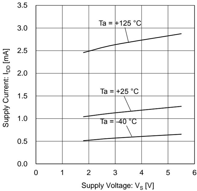
Figure 1. 回路電流 vs 電源電圧
