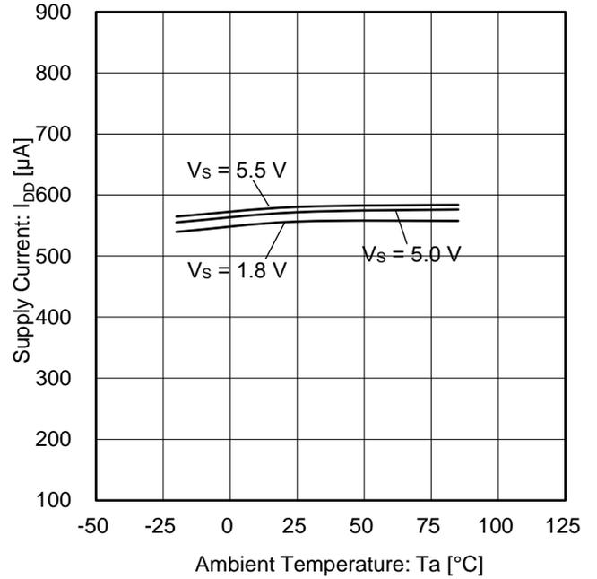
Figure 2. 回路電流 vs 温度
