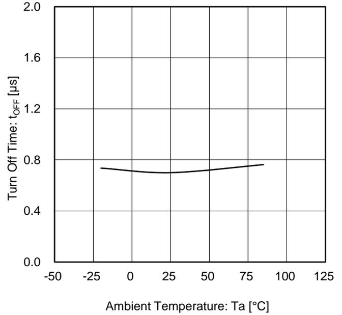
Figure 26. ターンオフ時間 vs 温度
