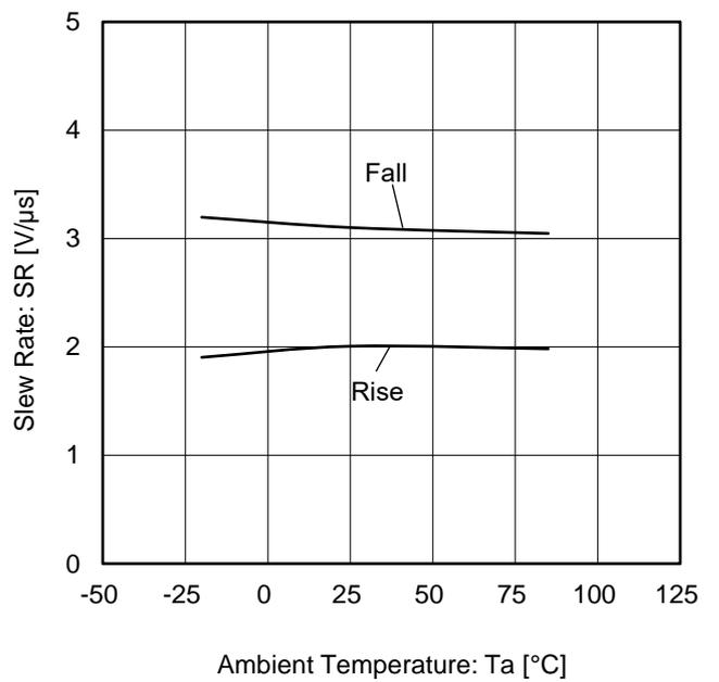
Figure 20. スルーレート vs 温度
