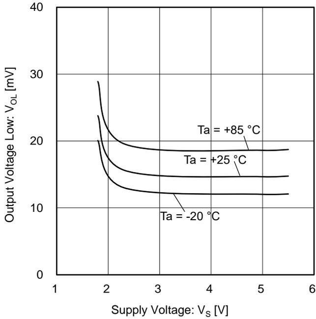
Figure 5. 出力電圧 Low vs 電源電圧
