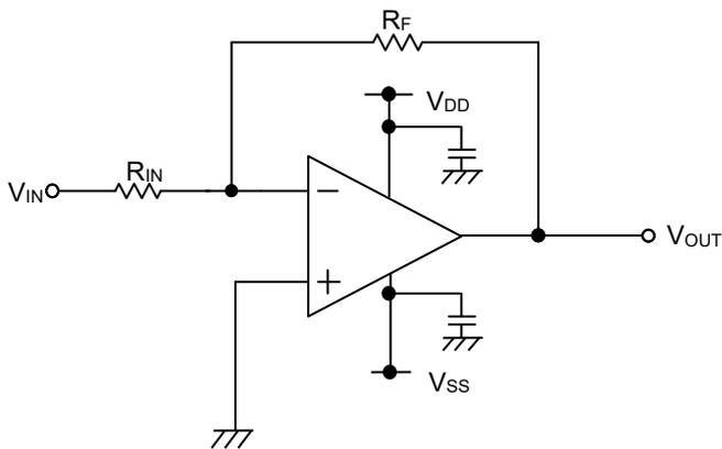
Figure 32. 反転増幅回路
