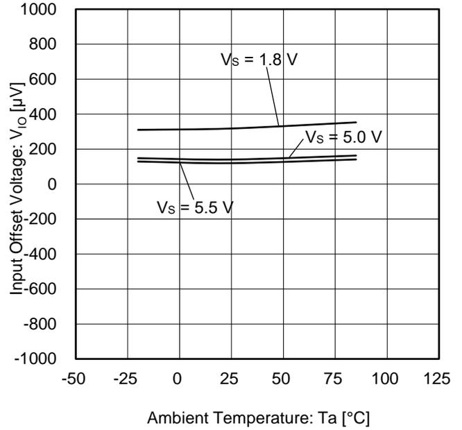
Figure 10. 入力オフセット電圧 vs 温度
