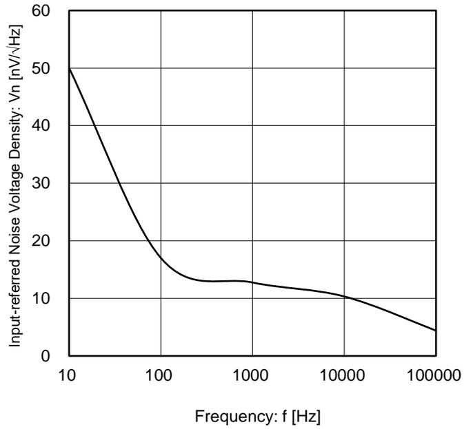
Figure 18. 入力換算雑音電圧密度 vs 周波数
