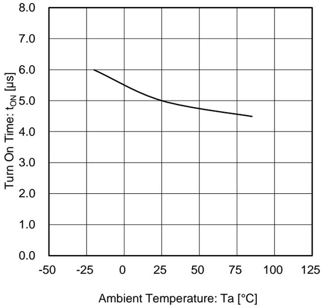
Figure 25. ターンオン時間 vs 温度
