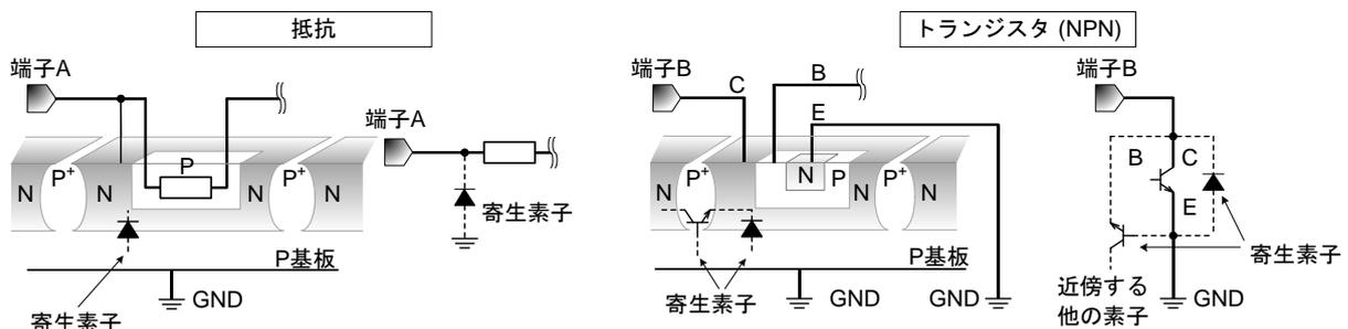
Figure 34. モノリシック IC 構造例
