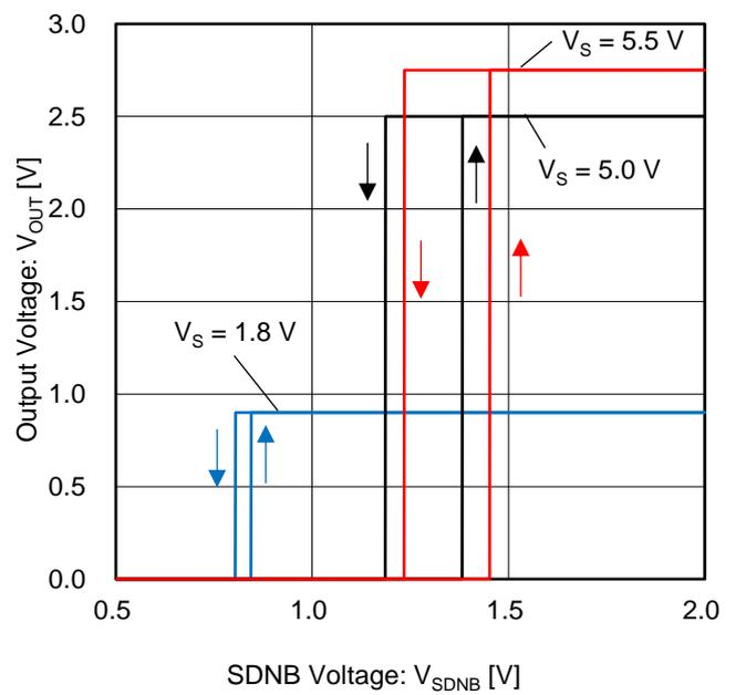
Figure 28. 出力電圧 vs SDNB 電圧
