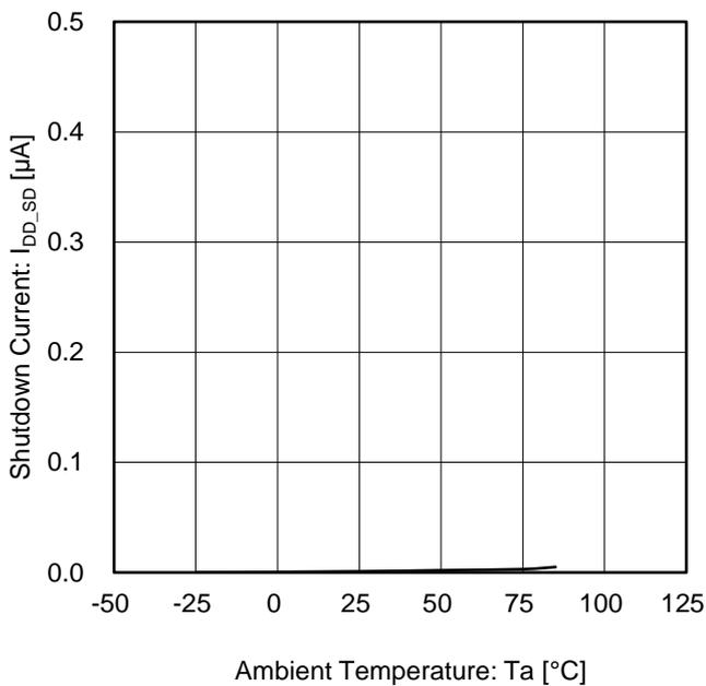
Figure 27. シャットダウン時回路電流 vs 温度
