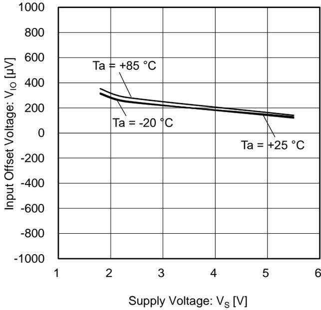
Figure 9. 入力オフセット電圧 vs 電源電圧
