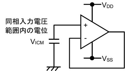
Figure 29. 未使用回路の処理例
