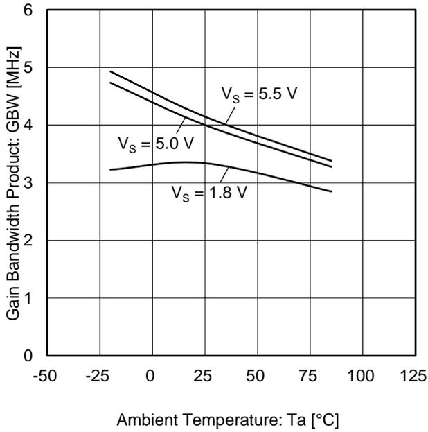
Figure 21. 利得帯域幅積 vs 温度
