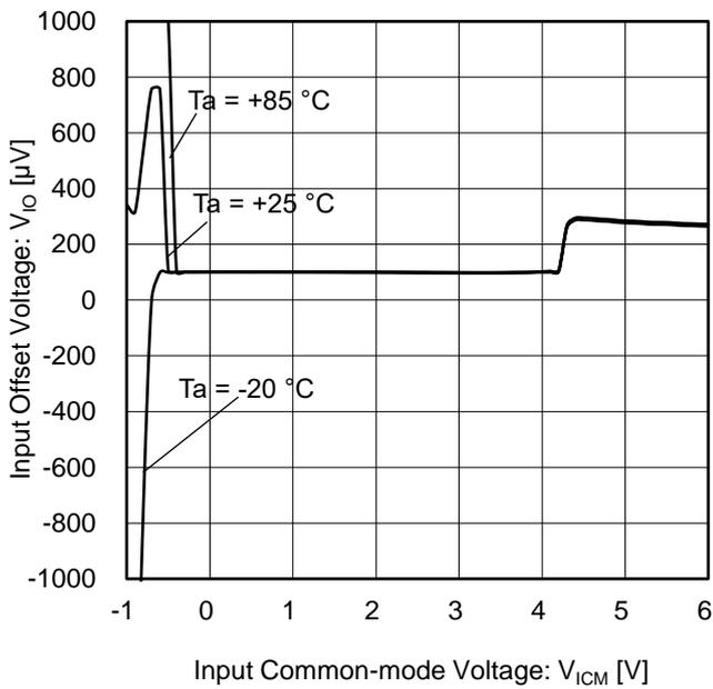
Figure 11. 入力オフセット電圧 vs 同相入力電圧
