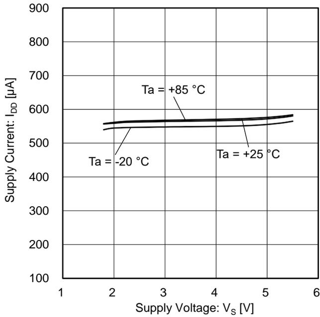
Figure 1. 回路電流 vs 電源電圧
