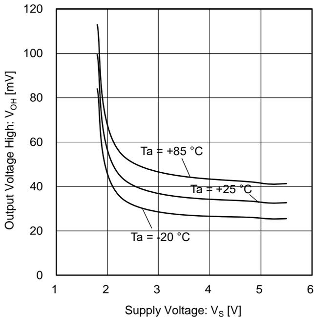
Figure 3. 出力電圧 High vs 電源電圧
