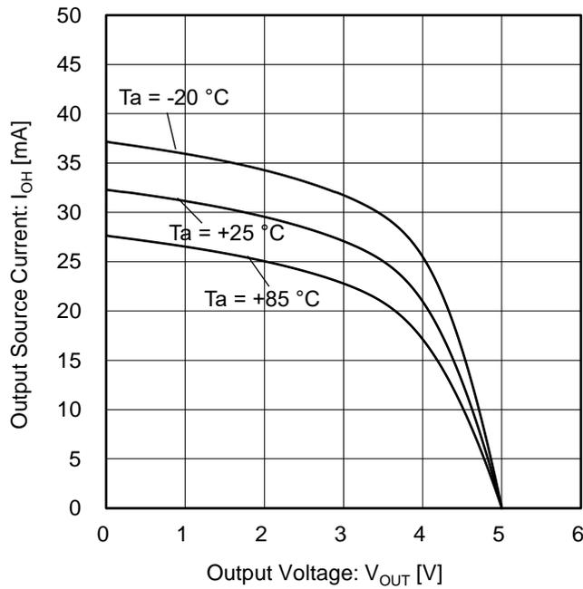
Figure 7. 出力ソース電流 vs 出力電圧
