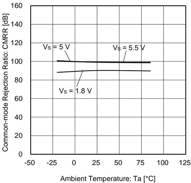
Figure 15. 同相信号除去比 vs 温度
