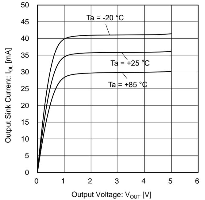
Figure 8. 出力シンク電流 vs 出力電圧
