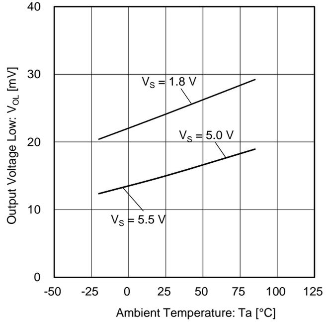
Figure 6. 出力電圧 Low vs 温度
