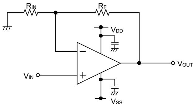
Figure 33. 非反転増幅回路
