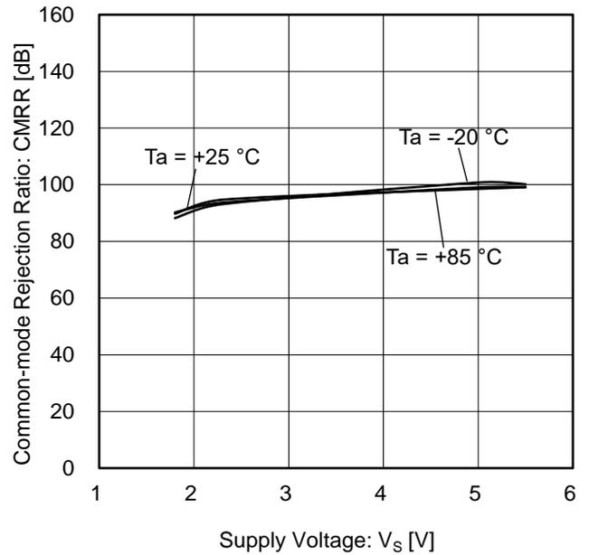
Figure 14. 同相信号除去比 vs 電源電圧
