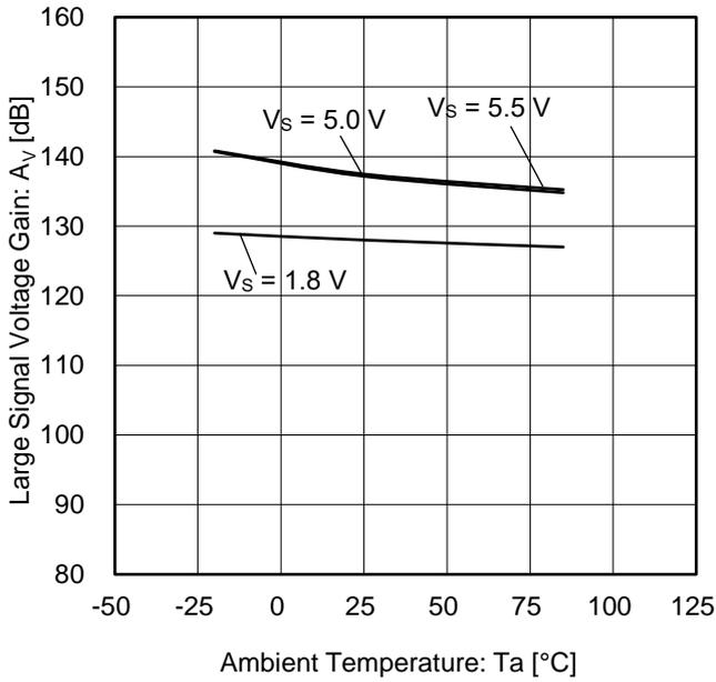
Figure 13. 大振幅電圧利得 vs 温度
