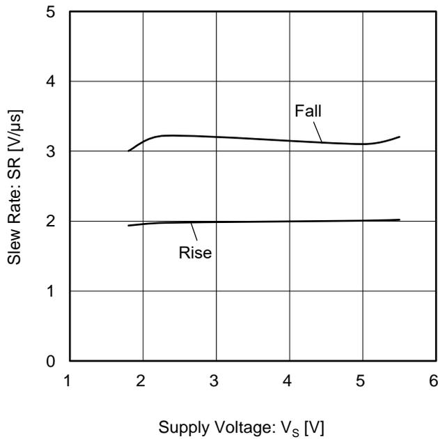
Figure 19. スルーレート vs 電源電圧
