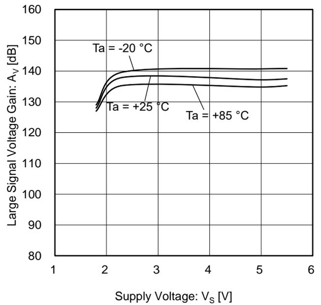
Figure 12. 大振幅電圧利得 vs 電源電圧
