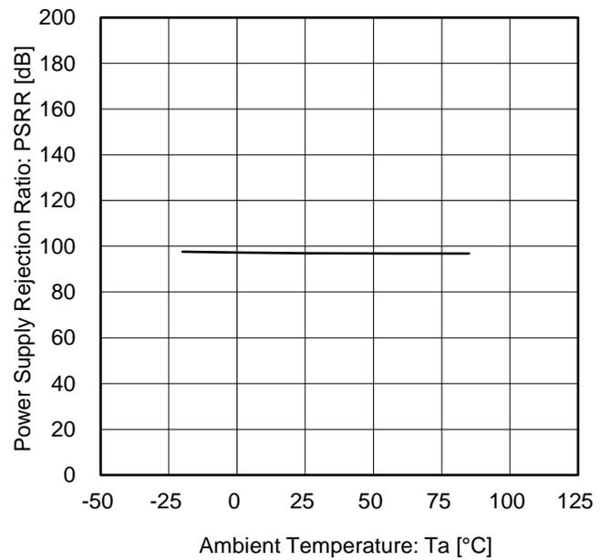
Figure 16. 電源電圧除去比 vs 温度
