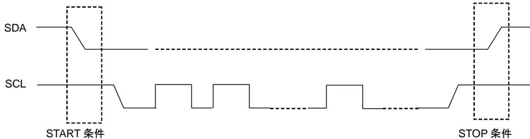
Figure 8. 2 線シリアルインタフェース Command/Data 転送フォーマット
