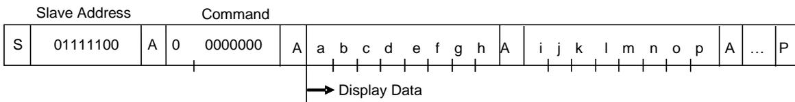
8bit のデータを DDRAM に書き込みます。書き込まれる Address は Address Set コマンドで指定された Address で、4bit ごとに自動的にインクリメントされます。
