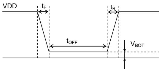
$t_R$ 、 $t_F$ 、 $t_{OFF}$ 、 $V_{BOT}$  の推奨条件 (Ta=+25°C)
