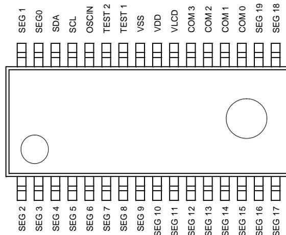
Figure 3. 端子配置図 (TOP VIEW)
