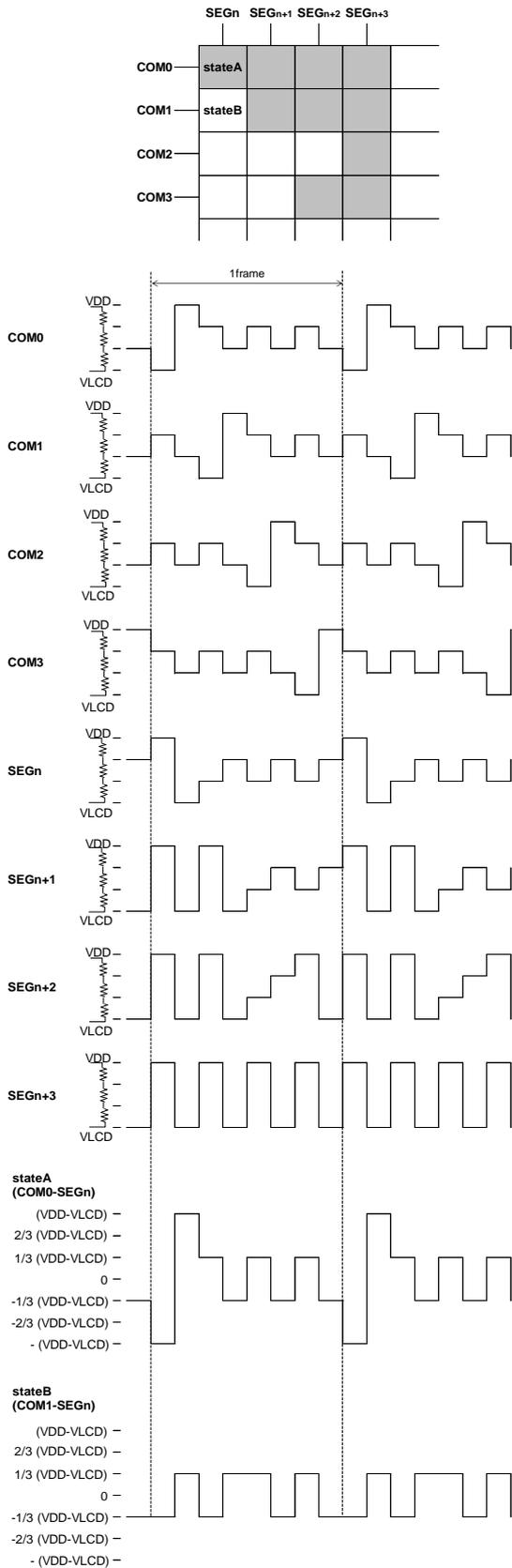
Figure 14. ライン反転時液晶駆動波形図(1/3bias)
