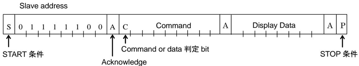
Figure 11. 2-SPI Command/Data 転送方法
