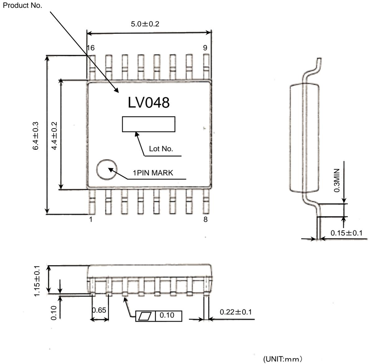
Fig.2 SSOP-B16 パッケージ外形及び標印図
