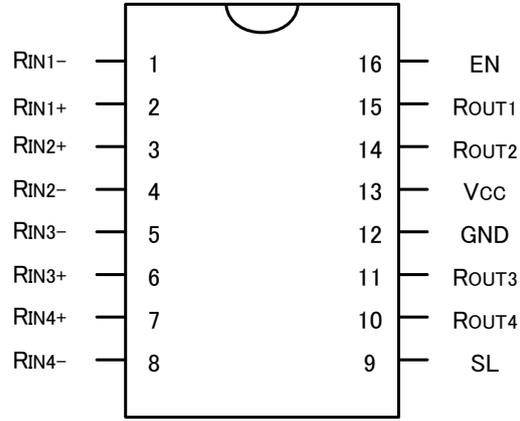
Fig.3 端子配置図 (Top View)
