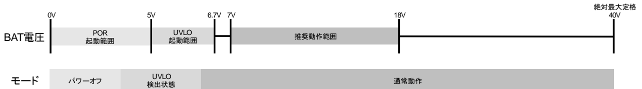
Figure 18. 電源電圧による内部状態(モード)
