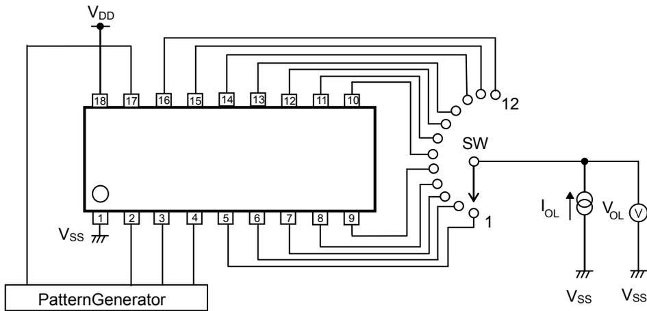
Figure 3. L 出力電圧測定回路
