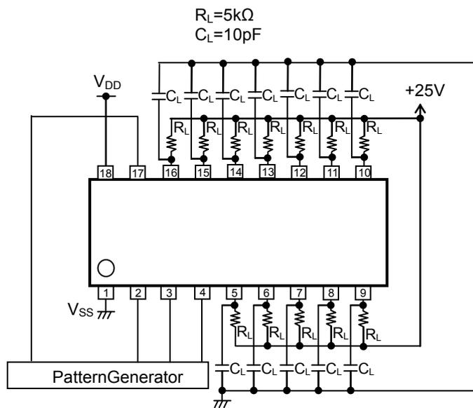
Figure 5. タイミング特性測定回路
