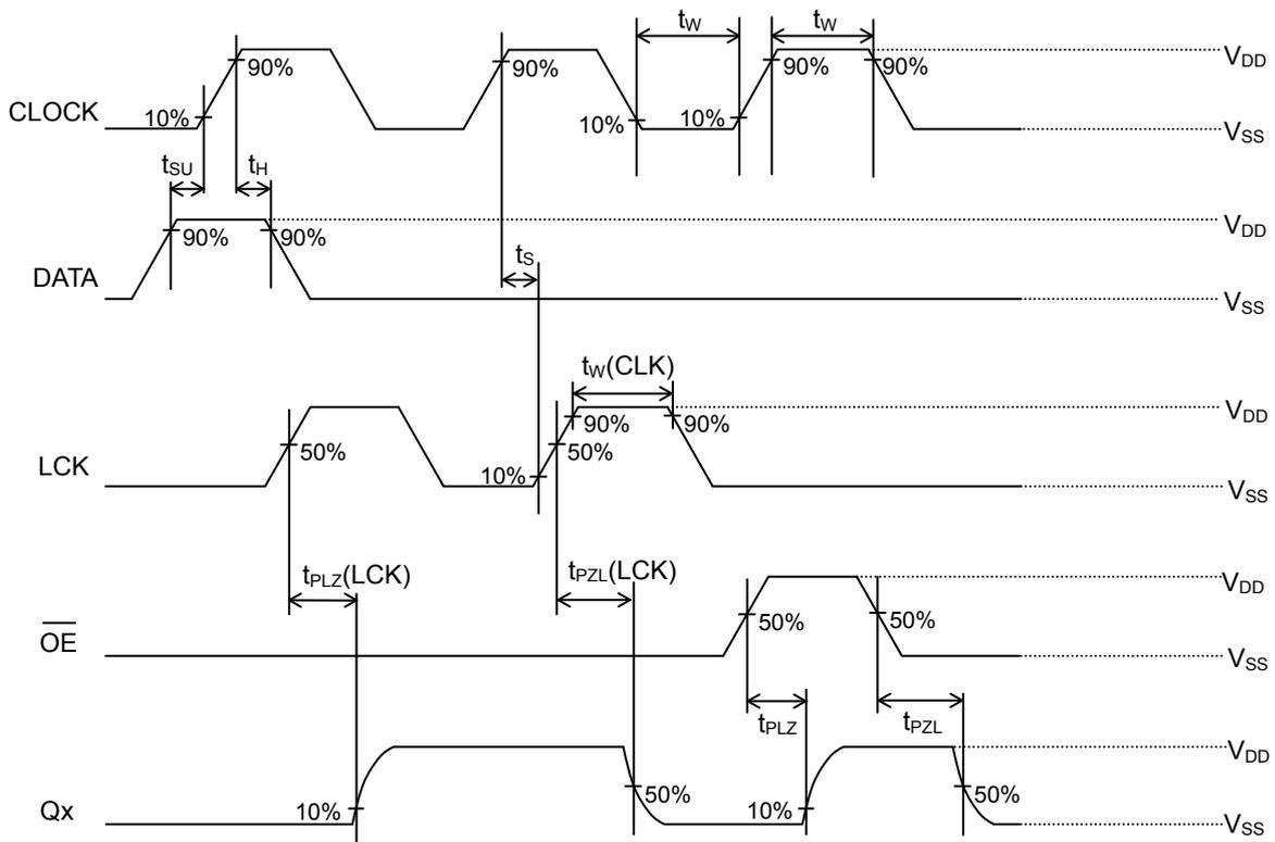
Figure 1 . タイミング特性測定波形
