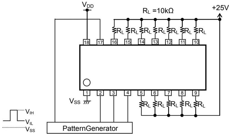
Figure 2. H/L 入力電圧測定回路
