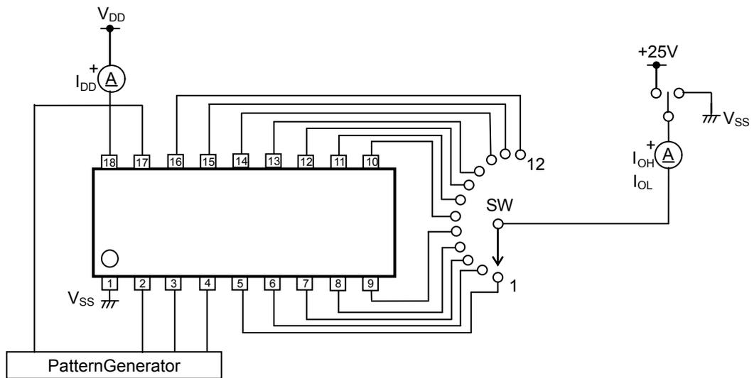
Figure 4. 出力リーク電流/静的消費電流 測定回路
