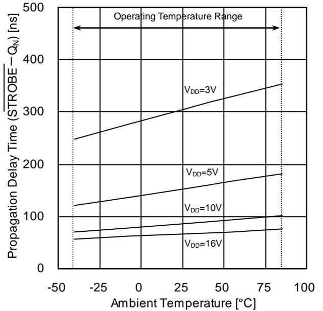
Figure 10. 伝達遅延時間  $t_{PHL}$  (STROBE-Q<sub>N</sub>) — 温度特性
