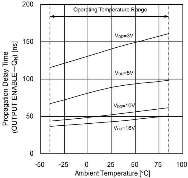
Figure 13. 伝達遅延時間  $t_{PZL}$  (OUTPUT ENABLE - Q<sub>N</sub>) - 温度特性
