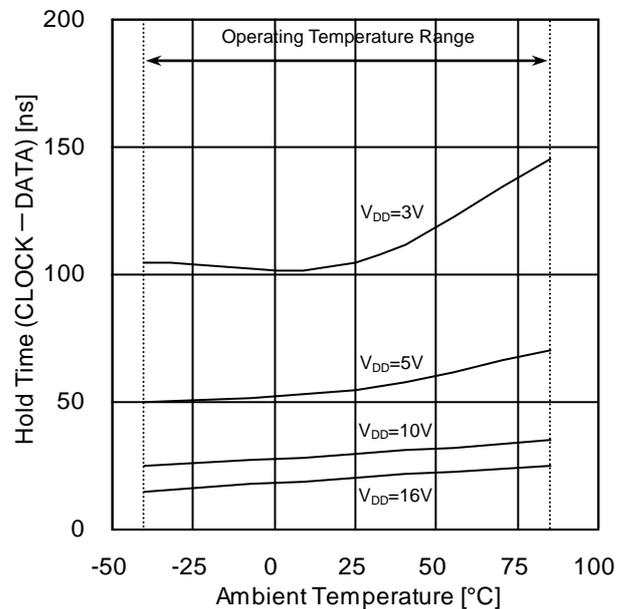
Figure 16. ホールド時間  $t_H$  (CLOCK - DATA) - 温度特性
