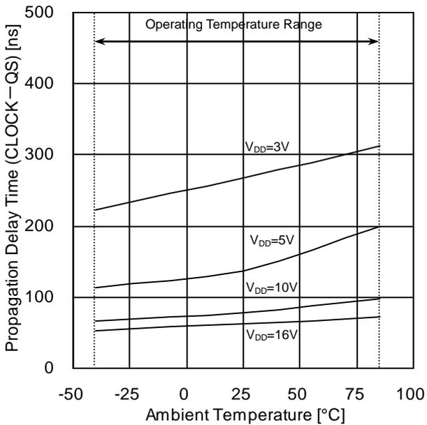
Figure 3. 伝達遅延時間  $t_{PLH}$  (CLOCK-QS) - 温度特性
