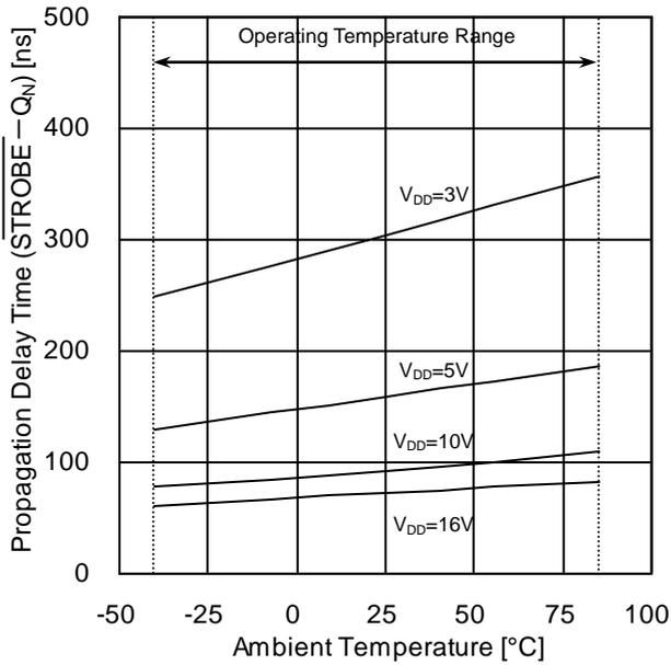
Figure 9. 伝達遅延時間  $t_{PLH}$  (STROBE-Q<sub>N</sub>) — 温度特性
