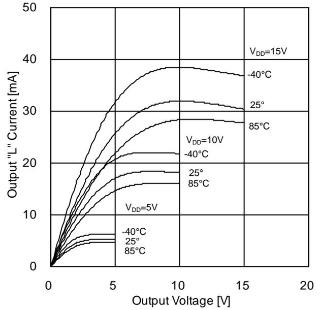
Figure 2. 出力シンク電流－出力電圧特性
