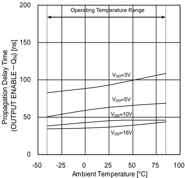
Figure 11. 伝達遅延時間  $t_{PZH}$  (OUTPUT ENABLE-Q<sub>N</sub>) — 温度特性
