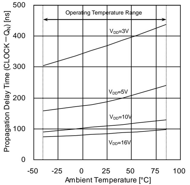
Figure 8. 伝達遅延時間  $t_{PHL}$  (CLOCK-Q<sub>N</sub>) - 温度特性
