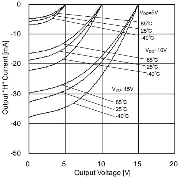
Figure 1. 出力ソース電流－出力電圧特性
