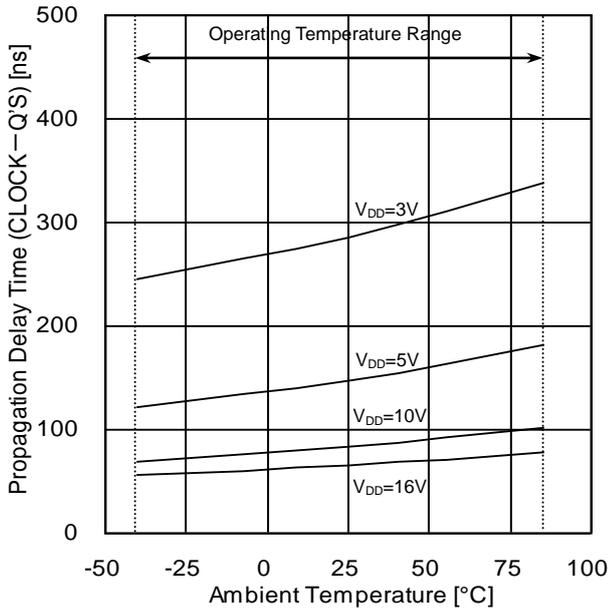
Figure 5. 伝達遅延時間  $t_{PLH}$  (CLOCK-Q'S) - 温度特性
