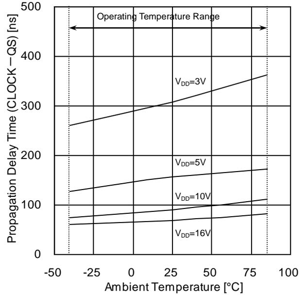
Figure 4. 伝達遅延時間  $t_{PHL}$  (CLOCK-QS) - 温度特性
