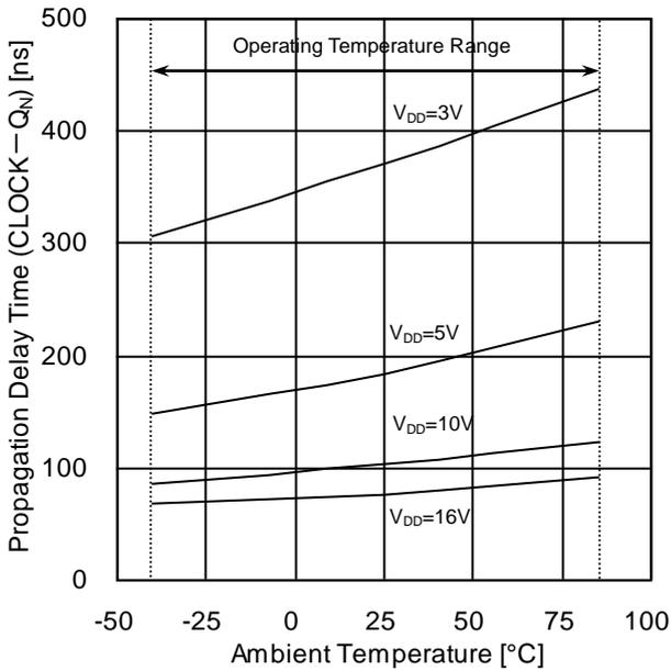
Figure 7. 伝達遅延時間  $t_{PLH}$  (CLOCK-Q<sub>N</sub>) - 温度特性
