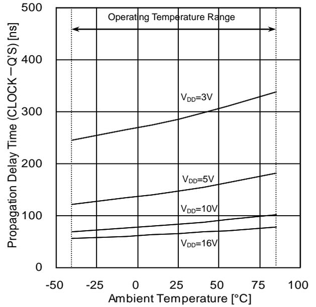
Figure 6. 伝達遅延時間  $t_{PHL}$  (CLOCK-Q'S) - 温度特性
