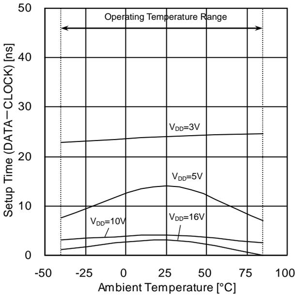
Figure 15. セットアップ時間  $t_{SU}$  (DATA - CLOCK) - 温度特性
