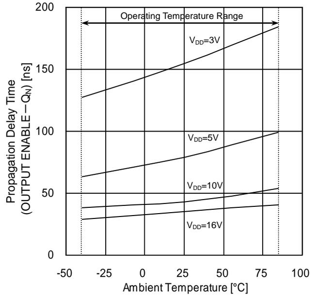
Figure 14. 伝達遅延時間  $t_{PLZ}$  (OUTPUT ENABLE - Q<sub>N</sub>) - 温度特性
