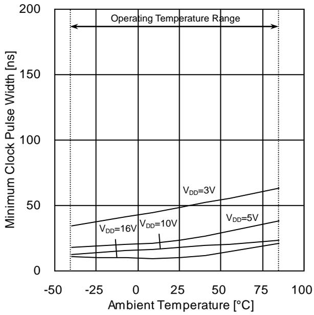
Figure 17. 最小クロックパルス幅  $t_w$  — 温度特性
