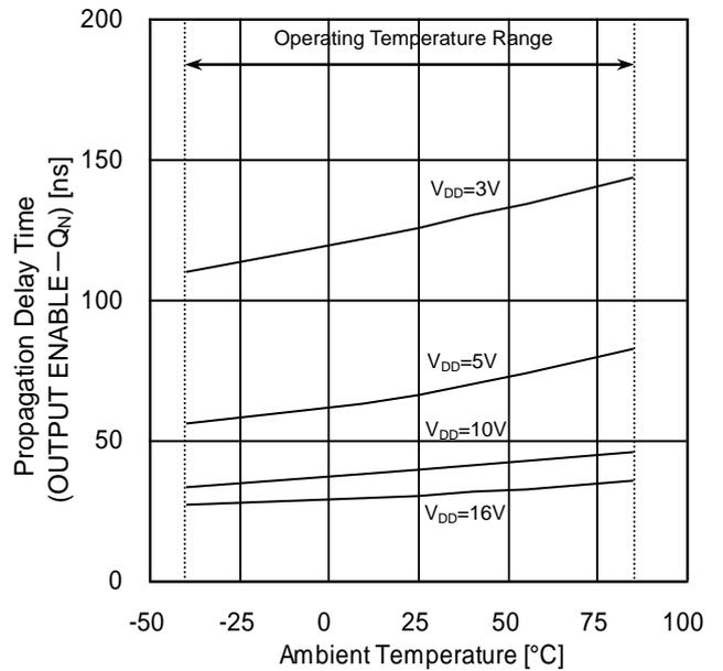
Figure 12. 伝達遅延時間  $t_{PHZ}$  (OUTPUT ENABLE-Q<sub>N</sub>) — 温度特性
