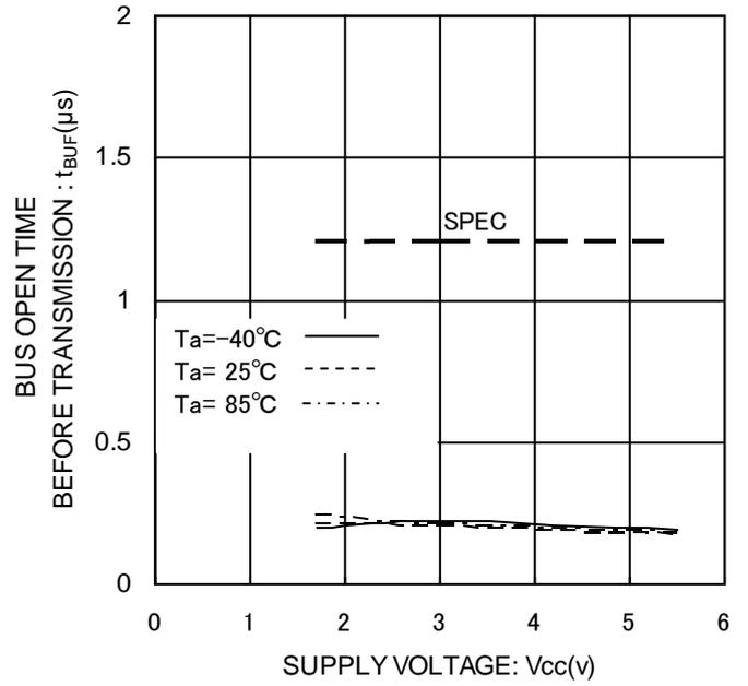
Figure 25. 転送開始前バス開放時間  $t_{buf}$
