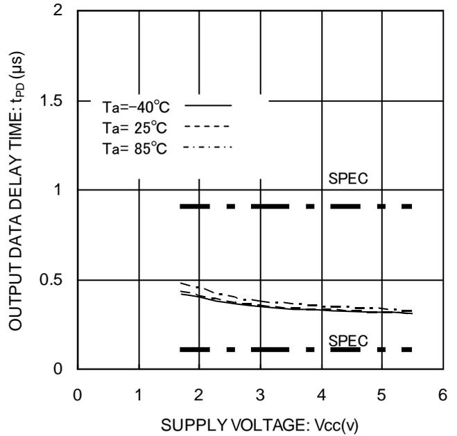
Figure 23. 'H'出力データ遅延時間  $t_{PD1}$
