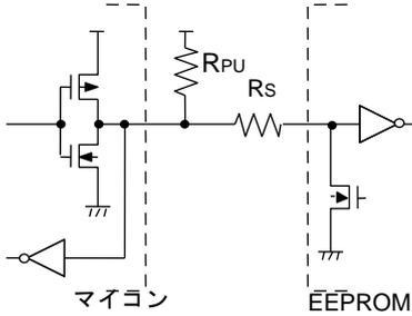
Figure 45. I/O 回路図
