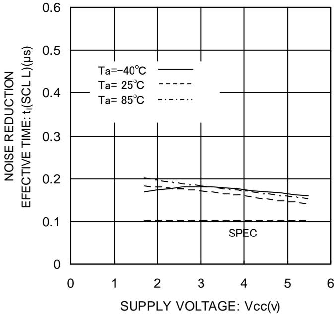
Figure 28. ノイズ除去有効時間  $t_i$ (SCL L)
