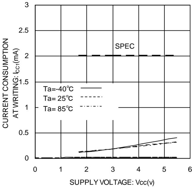
Figure 10. 動作時消費電流(ライト)  $I_{cc1}$
