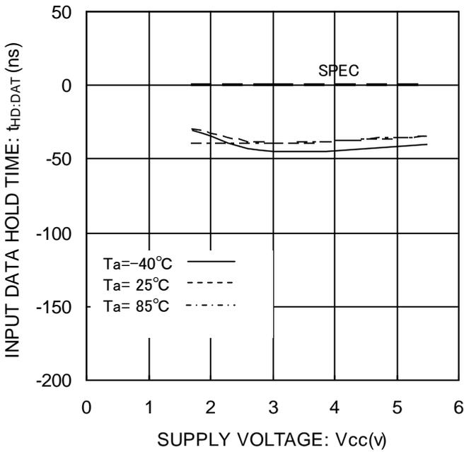
Figure 18. 入力データホールド時間  $t_{HD:DAT}$ (HIGH)
