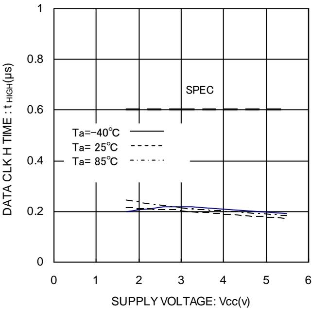
Figure 14. データクロック'H'時間  $t_{HIGH}$
