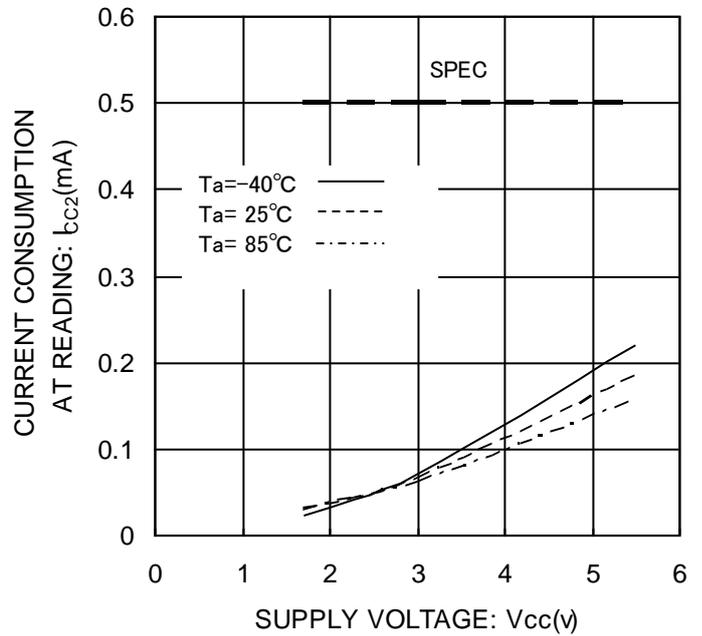
Figure 11. 動作時消費電流(リード)  $I_{cc2}$
