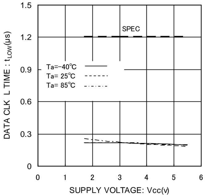
Figure 15. データクロック'L'時間  $t_{LOW}$
