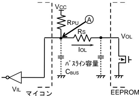
Figure 47. I/O 回路図
