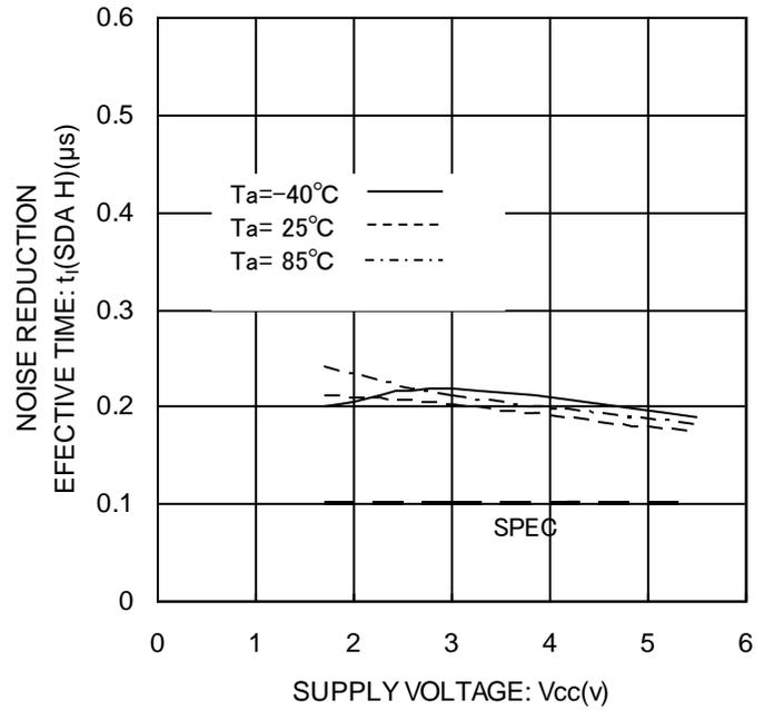
Figure 29. ノイズ除去有効時間  $t_i$ (SDA H)
