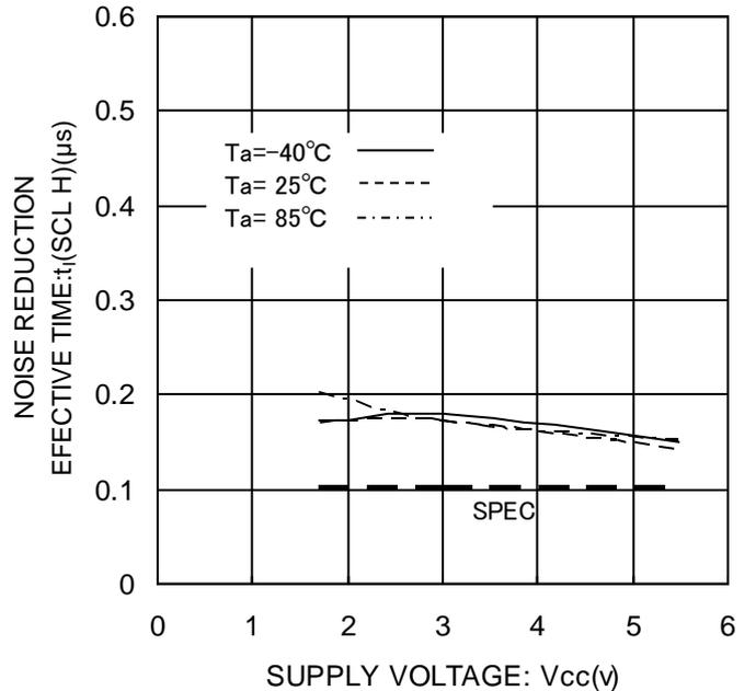
Figure 27. ノイズ除去有効時間  $t_i$  (SCL H)
