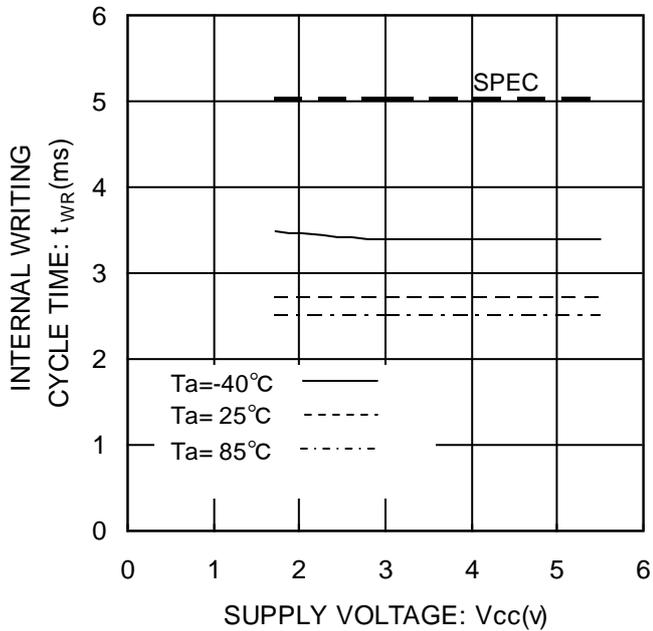
Figure 26. 内部書き込みサイクル時間  $t_{wr}$
