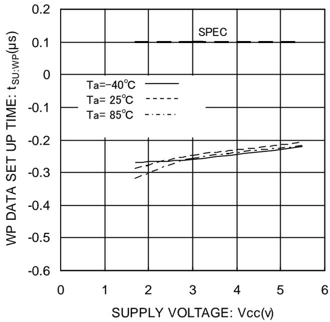
Figure 32. WP セットアップ時間  $t_{SU:WP}$
