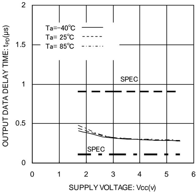
Figure 22. 'L'出力データ遅延時間  $t_{PD0}$
