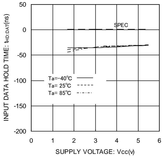
Figure 19. 入力データホールド時間  $t_{HD:DAT}$ (LOW)
