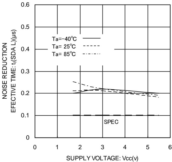
Figure 30. ノイズ除去有効時間  $t_i$ (SDA L)
