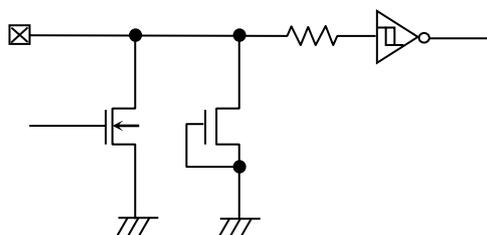
Figure 50. 入出力 pin 回路図
