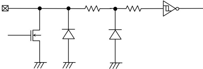
Figure 57. 入出力 pin 回路図
