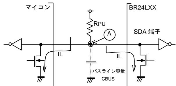
Figure 51. I/O 回路図
