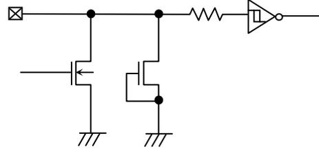
Figure 51. 入出力 pin 回路図
