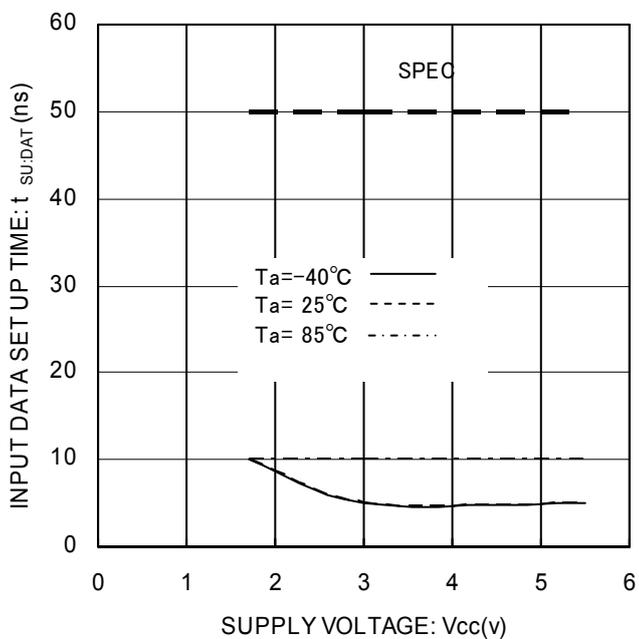
Figure 22. 入力データセットアップ時間  $t_{SU:DAT}$  (LOW)
