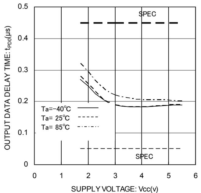
Figure 23. “L”出力データ遅延時間  $t_{PDO}$
