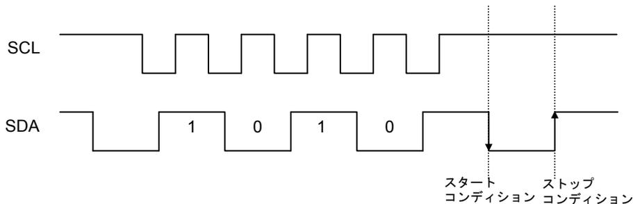
Figure 44.スレーブアドレス入力中にスタート・ストップコンディションでキャンセルした場合
