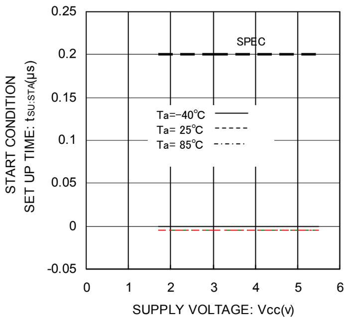
Figure 18. スタートコンディションセットアップ時間  $t_{SU:STA}$
