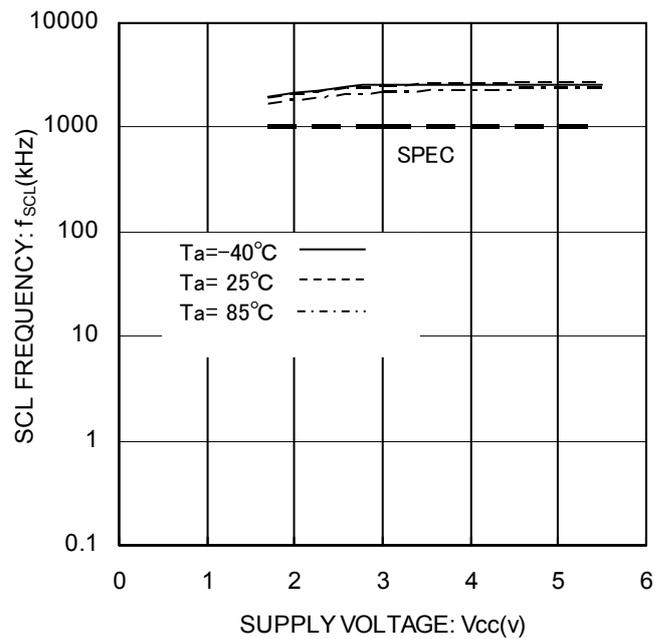
Figure 13. SCL 周波数  $f_{SCL}$
