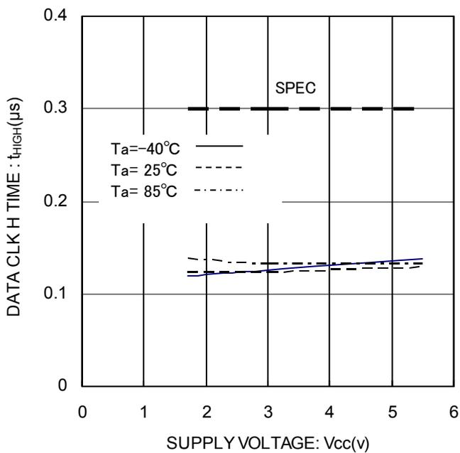
Figure 14. データクロック“H”時間  $t_{HIGH}$
