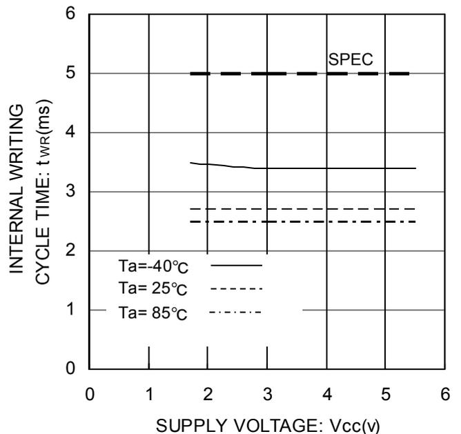
Figure 27. 内部書き込みサイクル時間  $t_{WR}$
