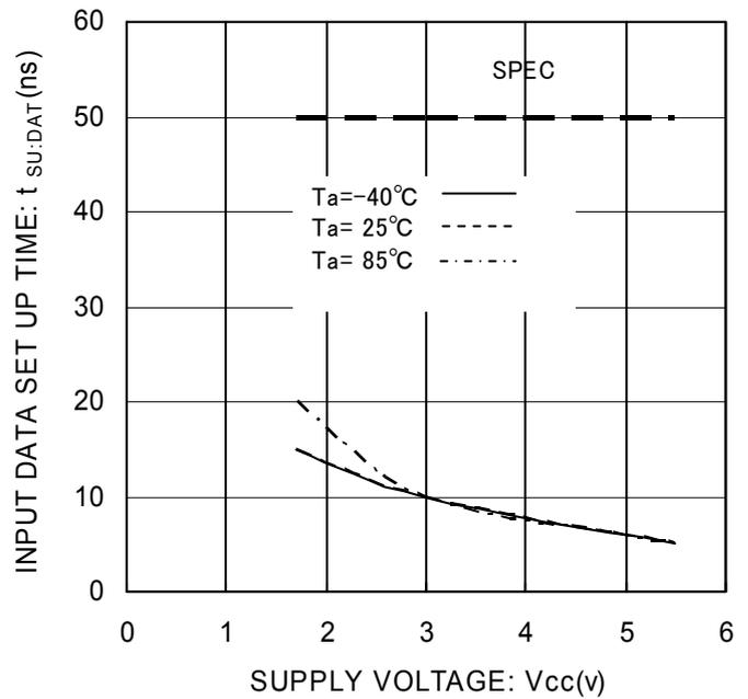
Figure 21. 入力データセットアップ時間  $t_{SU:DAT}$  (HIGH)
