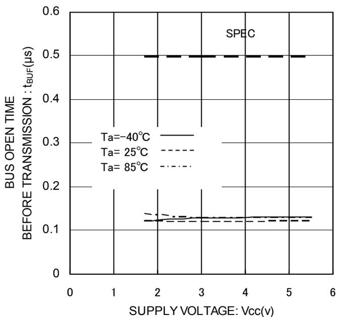
Figure 26. 転送開始前バス開放時間  $t_{BUF}$
