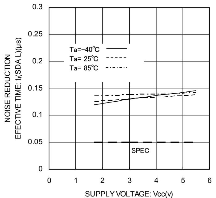
Figure 31. ノイズ除去有効時間  $t_1$ (SDA L)
