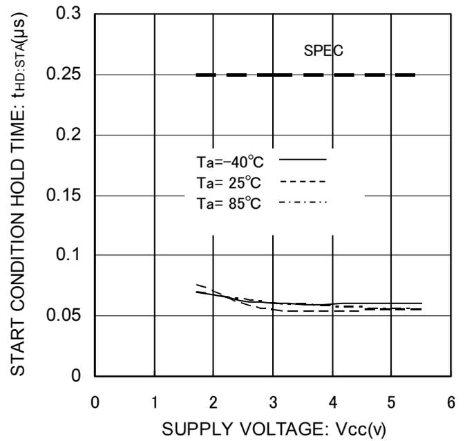
Figure 17. スタートコンディションホールド時間  $t_{HD:STA}$
