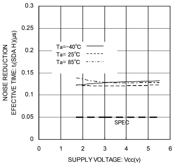
Figure 30. ノイズ除去有効時間  $t_1$ (SDA H)
