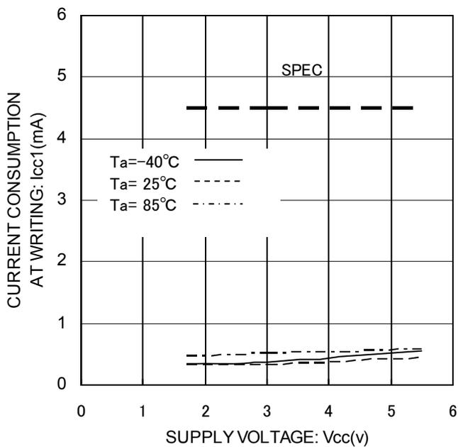
Figure 10. ライト動作時消費電流  $I_{CC1}$
