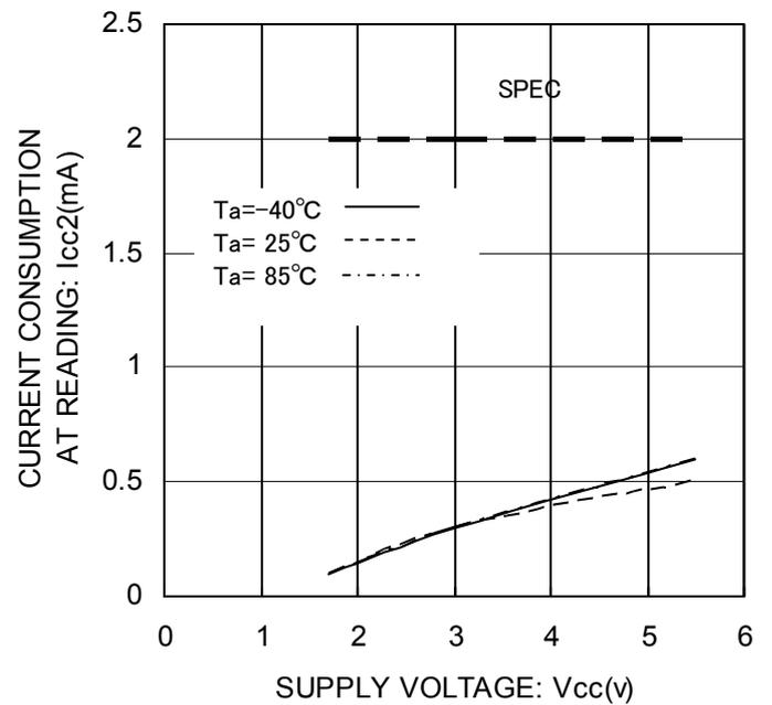
Figure 11. リード動作時消費電流  $I_{CC2}$
