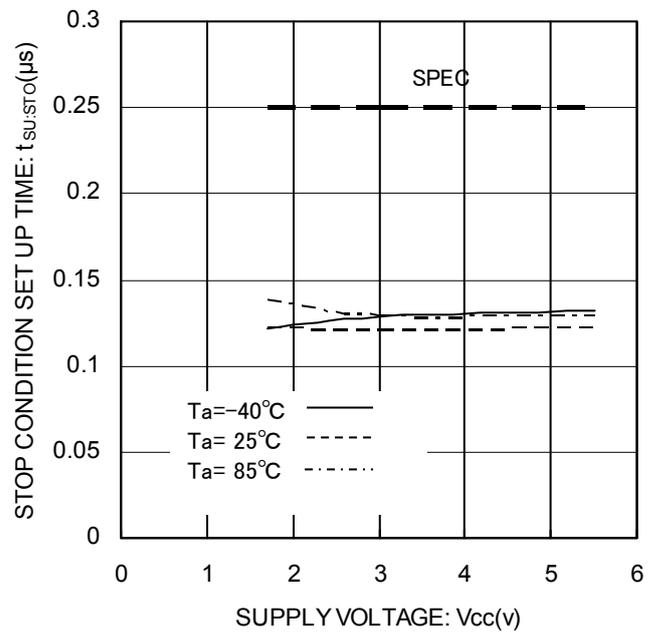
Figure 25. ストップコンディションセットアップ時間  $t_{SU,STO}$
