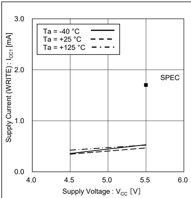
Figure 15. 消費電流 (ライト) vs 電源電圧
