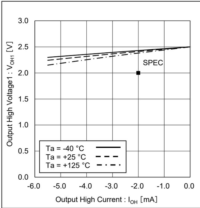
Figure 11. 'HIGH'出力電圧 1 vs 'HIGH'出力電流
