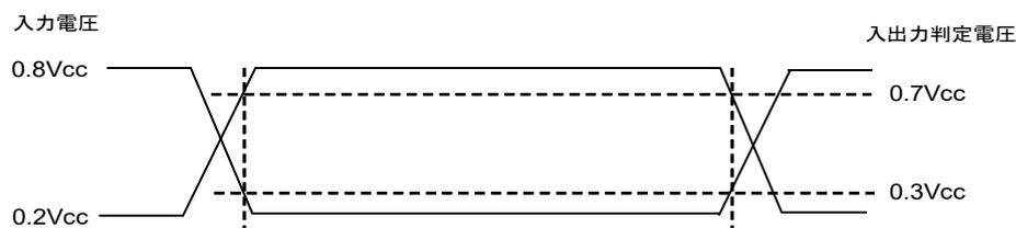
Figure 5. 入力電圧、入出力判定電圧
