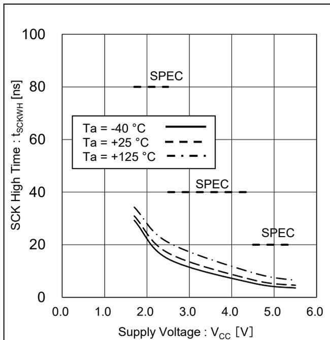
Figure 21. SCK ハイ時間 vs 電源電圧
