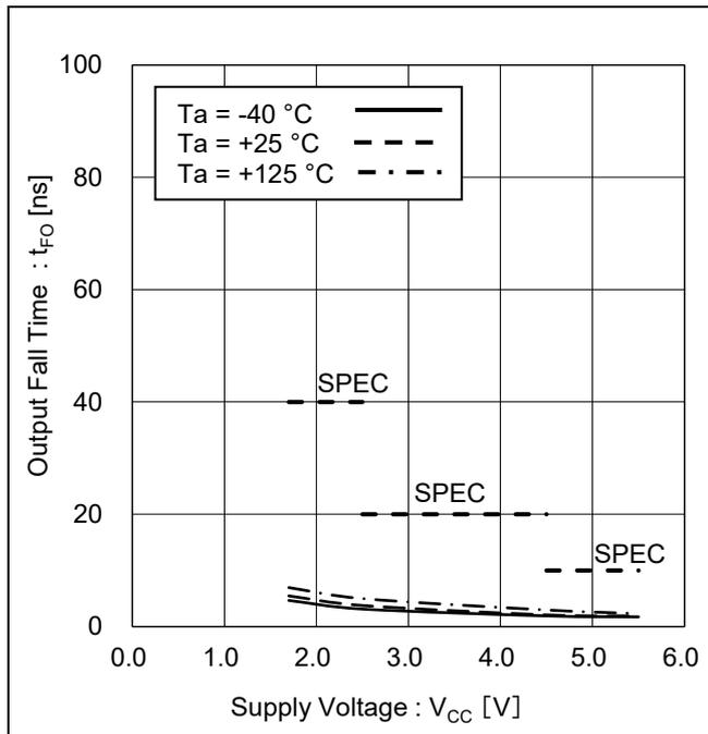
Figure 35. 出力立ち下がり時間 vs 電源電圧
