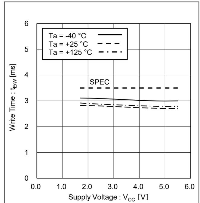
Figure 36. 書き込み時間 vs 電源電圧
