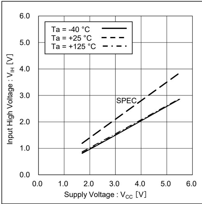
Figure 7. 'HIGH'入力電圧 vs 電源電圧
