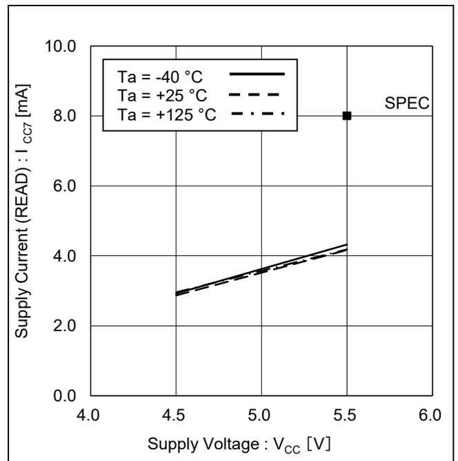
Figure 18. 消費電流 (リード) vs 電源電圧
