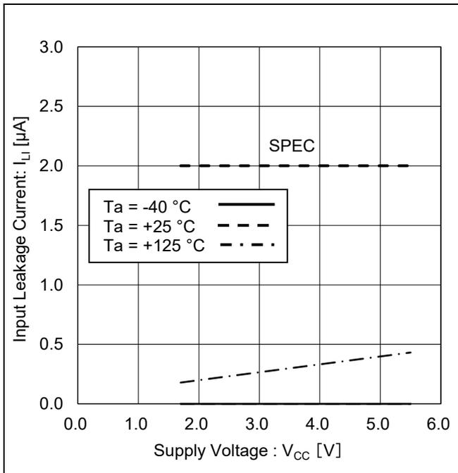
Figure 13. 入力リーク電流 vs 電源電圧
