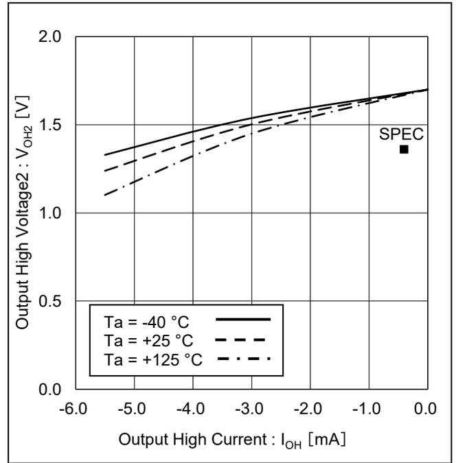
Figure 12. 'HIGH'出力電圧 2 vs 'HIGH'出力電流
