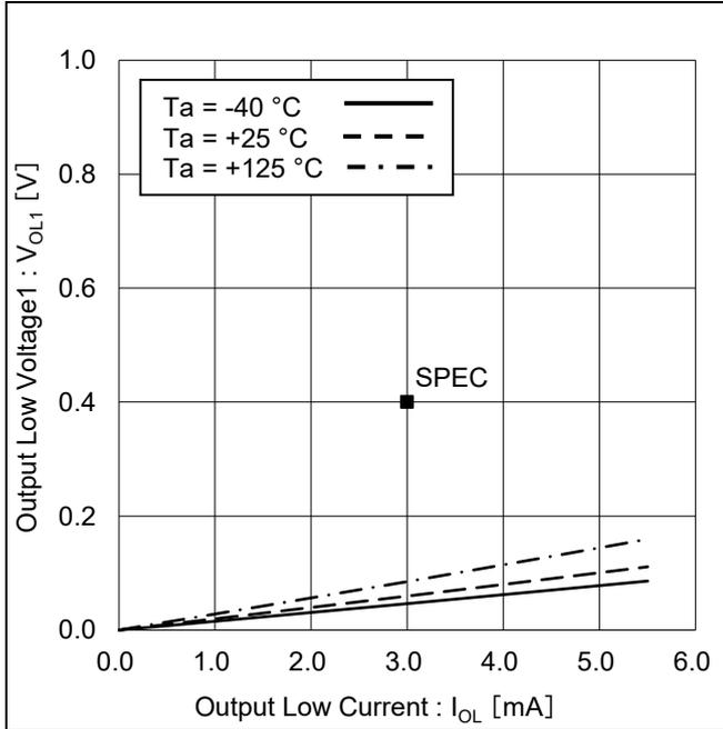
Figure 9. 'LOW'出力電圧 1 vs 'LOW'出力電流
