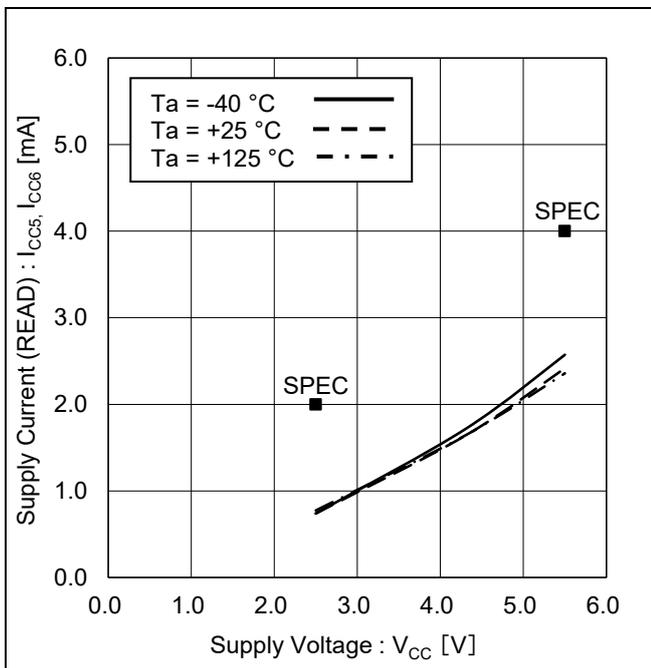
Figure 17. 消費電流 (リード) vs 電源電圧
