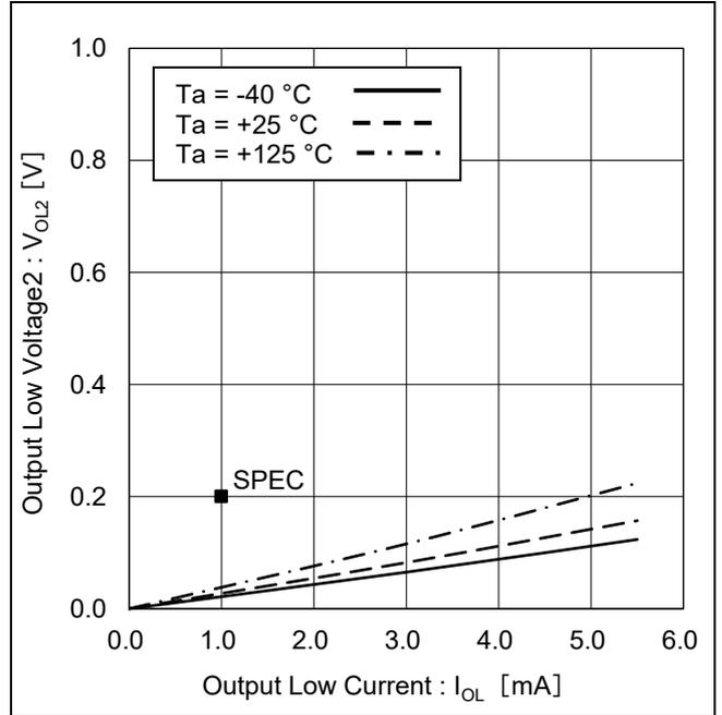
Figure 10. 'LOW'出力電圧 2 vs 'LOW'出力電流
