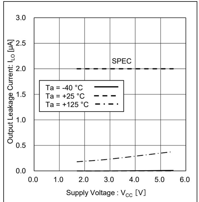
Figure 14. 出力リーク電流 vs 電源電圧
