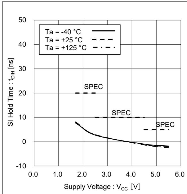
Figure 27. SI ホールド時間 vs 電源電圧
