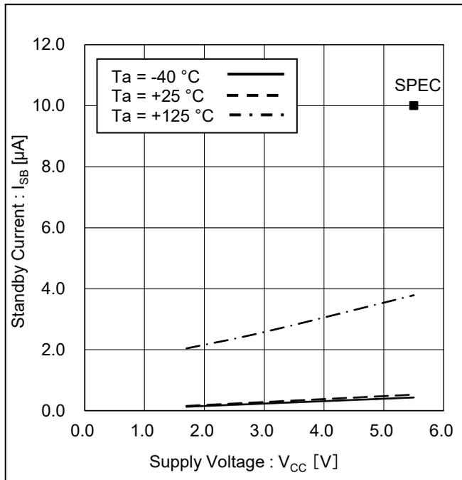
Figure 19. スタンバイ電流 vs 電源電圧
