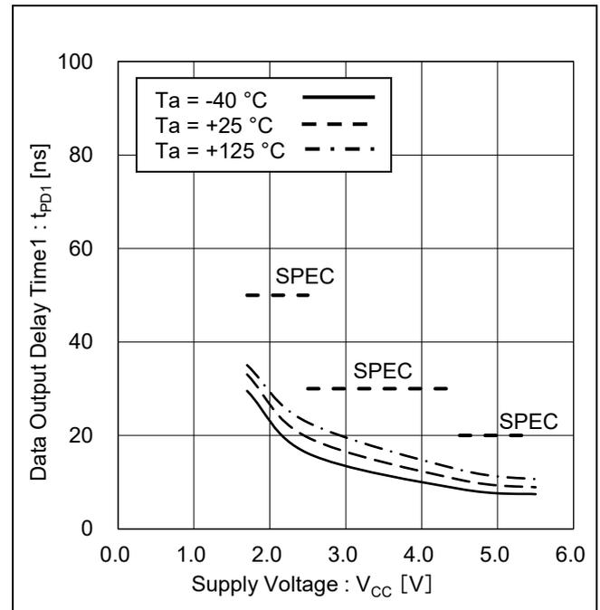
Figure 28. データ出力遅延時間 1 vs 電源電圧
