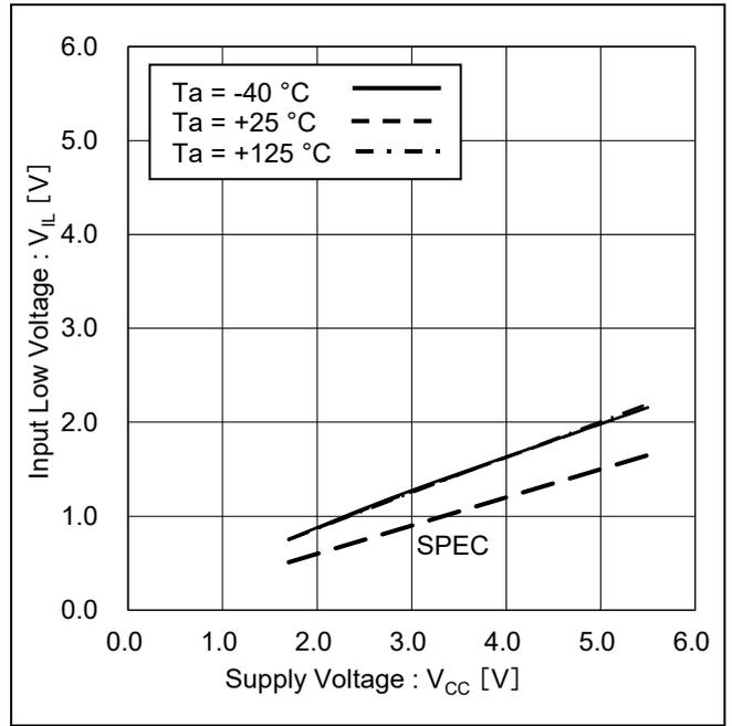
Figure 8. 'LOW'入力電圧 vs 電源電圧
