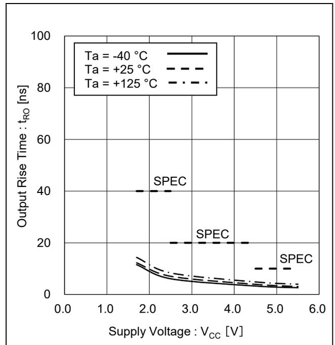
Figure 34. 出力立ち上がり時間 vs 電源電圧
