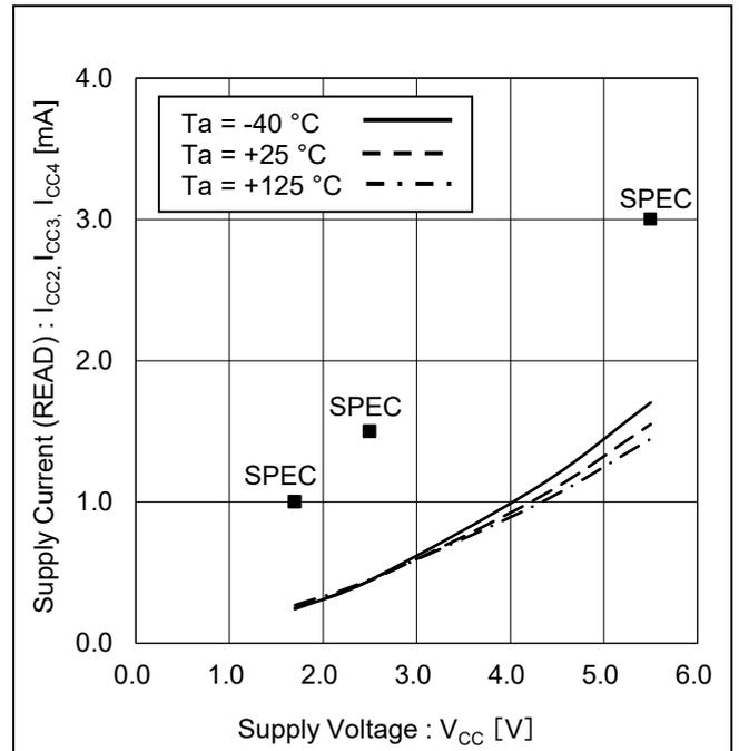
Figure 16. 消費電流 (リード) vs 電源電圧
