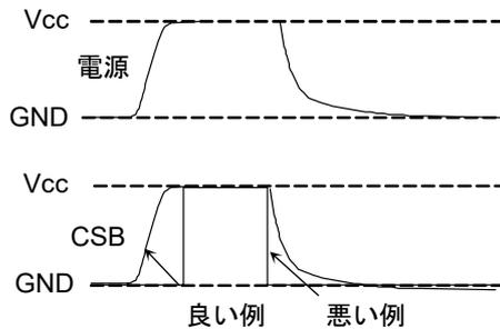
Figure 63. 電源 ON/OFF 時の CSB タイミング
