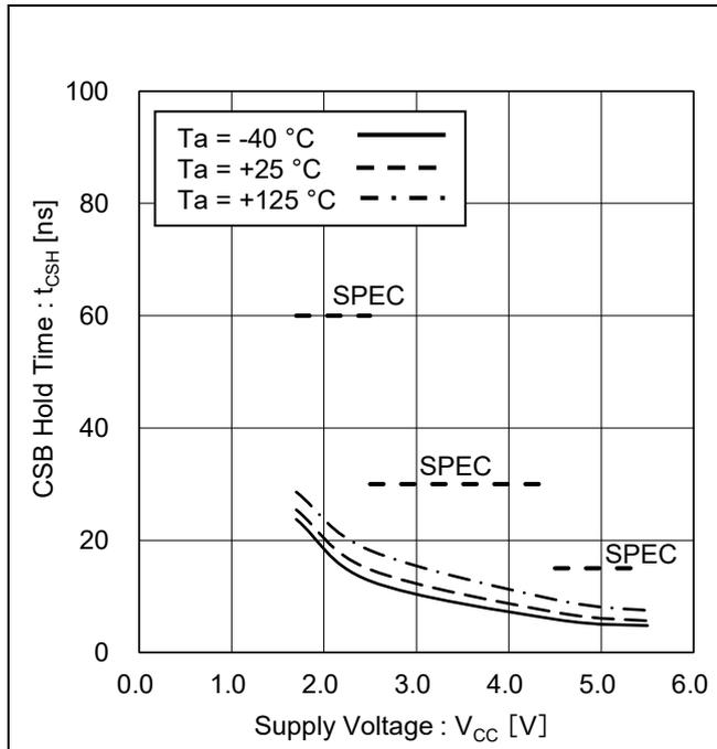
Figure 25. CSB ホールド時間 vs 電源電圧
