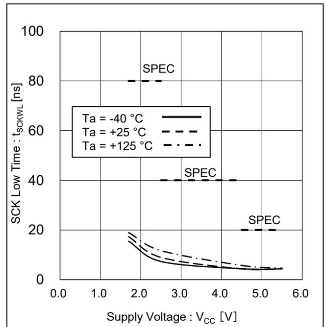
Figure 22. SCK ロウ時間 vs 電源電圧
