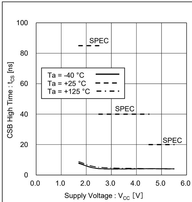
Figure 23. CSB ハイ時間 vs 電源電圧
