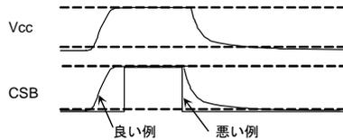
Figure 52. 電源 ON/OFF 時の CSB タイミング
