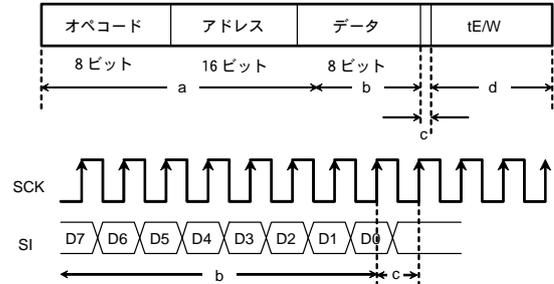
Figure 40. WRITE キャンセル有効タイミング
