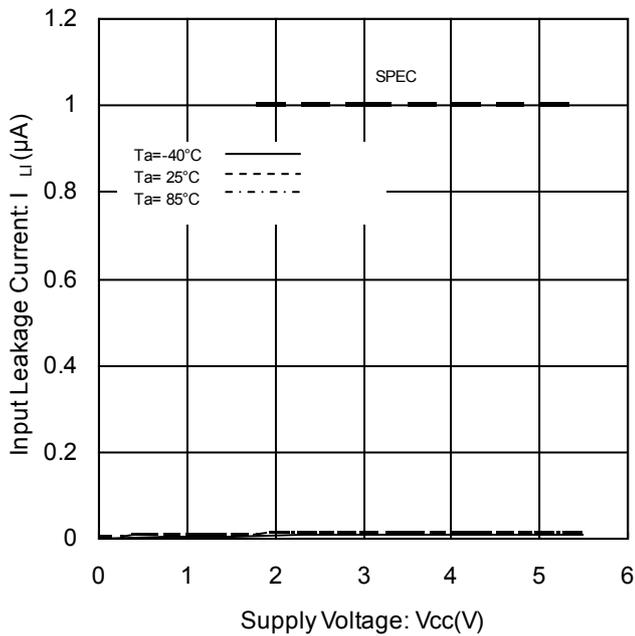
Figure 8. 入力リーク電流 vs 電源電圧 (SCL,WP,TEST)
