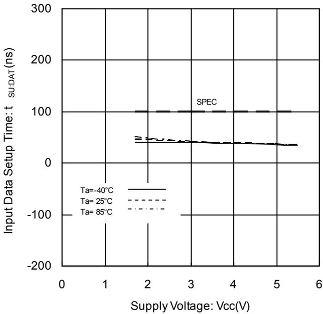
Figure 20. 入力データセットアップ時間 vs 電源電圧 (HIGH)
