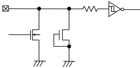
Figure 50. 入出力 pin 回路図
