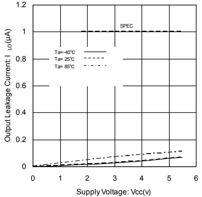
Figure 9. 出力リーク電流 vs 電源電圧 (SDA)
