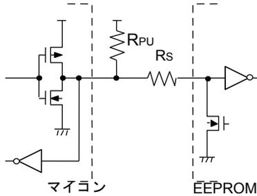
Figure 45. I/O 回路図
