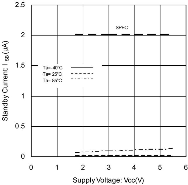
Figure 12. スタンバイ電流 vs 電源電圧
