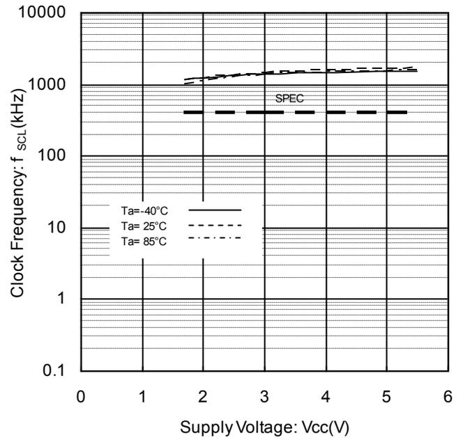
Figure 13. SCL 周波数 vs 電源電圧
