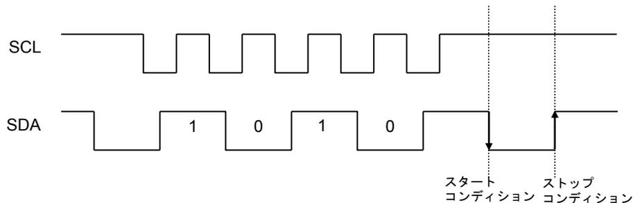
Figure 43. スレーブアドレス入力中にスタート・ストップコンディションでキャンセルした場合
