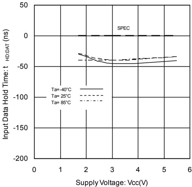
Figure 18. 入力データホールド時間 vs 電源電圧 (HIGH)
