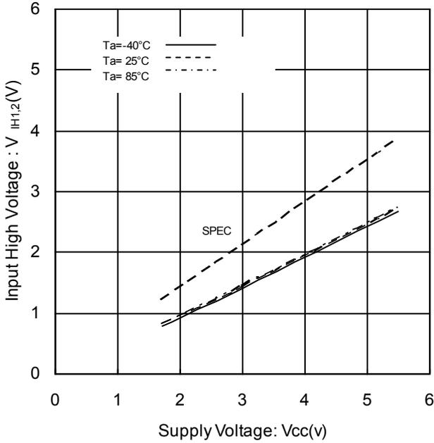
Figure 4. “H”入力電圧 1,2 vs 電源電圧
