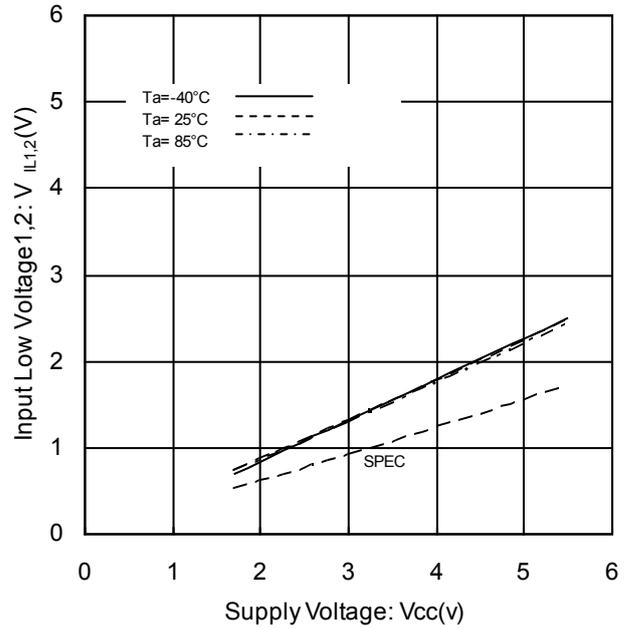
Figure 5. “L”入力電圧 1,2 vs 電源電圧
