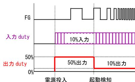
Figure 40. 入力 duty10%時の起動補助動作
