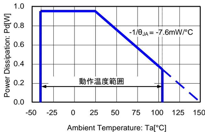
Figure 52. 許容損失 vs 周囲温度
