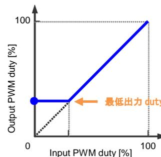
Figure 25. 最低出力 duty 設定
