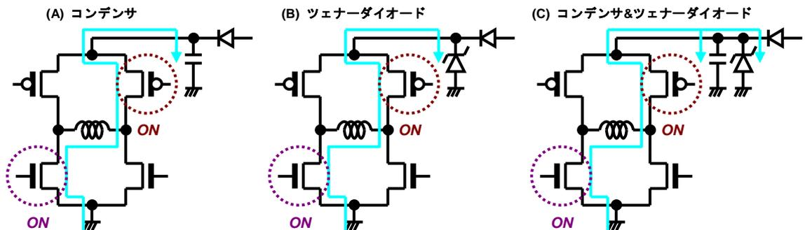
Figure 48. V<sub>CC</sub> 電圧上昇の対策
