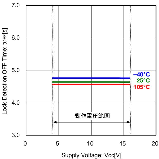
Figure 9. ロック検出 OFF 時間 vs 電源電圧
