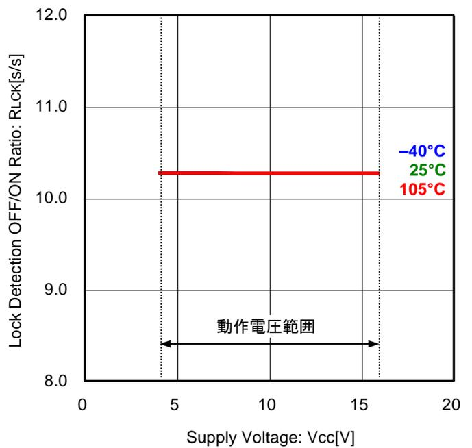
Figure 10. ロック検出 OFF/ON 比 vs 電源電圧
