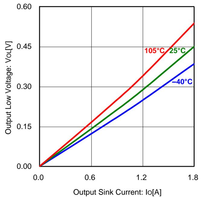
Figure 6. 出力 Low 電圧 vs 出力流入電流 (Vcc=12V)
