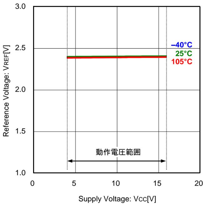
Figure 17. 基準電圧 vs 電源電圧 (V<sub>cc</sub>=12V)
