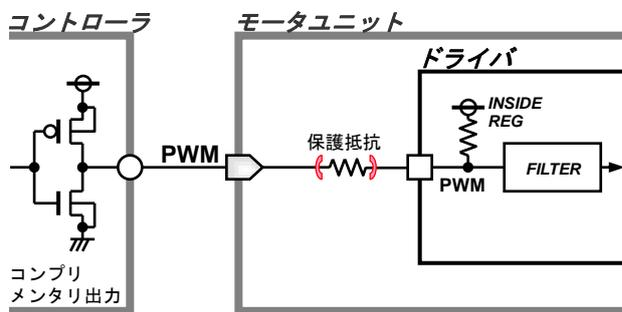
Figure 22. PWM duty 入力可変速制御アプリケーション
