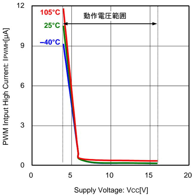
Figure 15. PWM 入力 High 電流 vs 電源電圧 (V<sub>PWM</sub>=5V)
