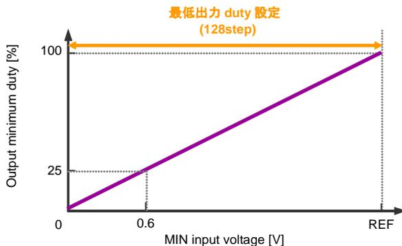
Figure 24. MIN 電圧と出力 duty の関係
