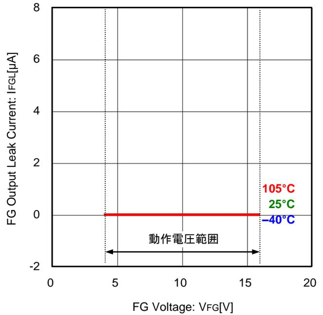
Figure 14. FG 出力リーク電流 vs FG 電圧
