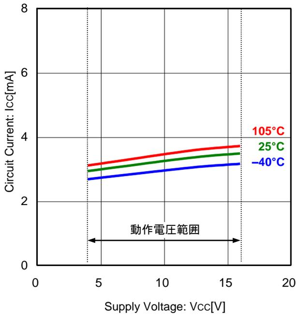
Figure 3. 回路電流 vs 電源電圧
