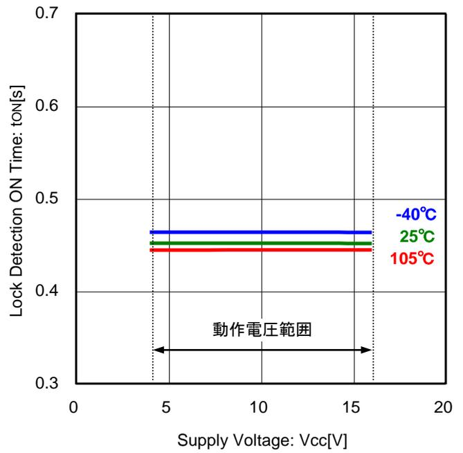
Figure 8. ロック検出 ON 時間 vs 電源電圧
