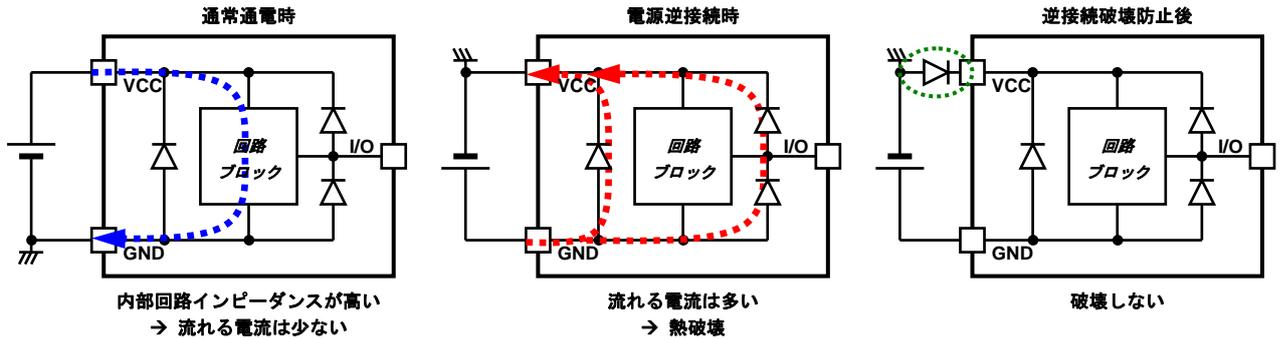
Figure 46. 電源逆接続時の電流の流れ
