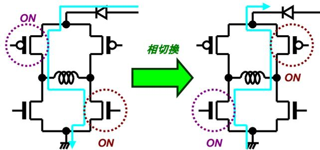
Figure 37. 誘導起電力による  $V_{CC}$  電圧上昇
