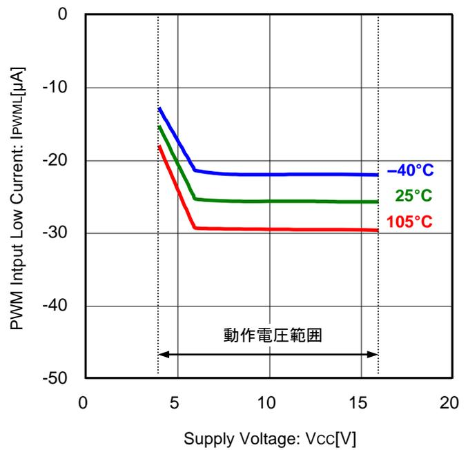
Figure 16. PWM 入力 Low 電流 vs 電源電圧 (V<sub>PWM</sub>=0V)
