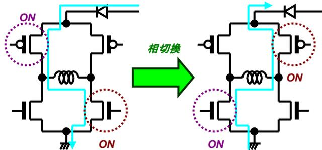
Figure 47. 誘導起電力による V<sub>CC</sub> 電圧上昇
