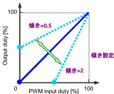
Figure 28. 入出力 duty の傾き調整
