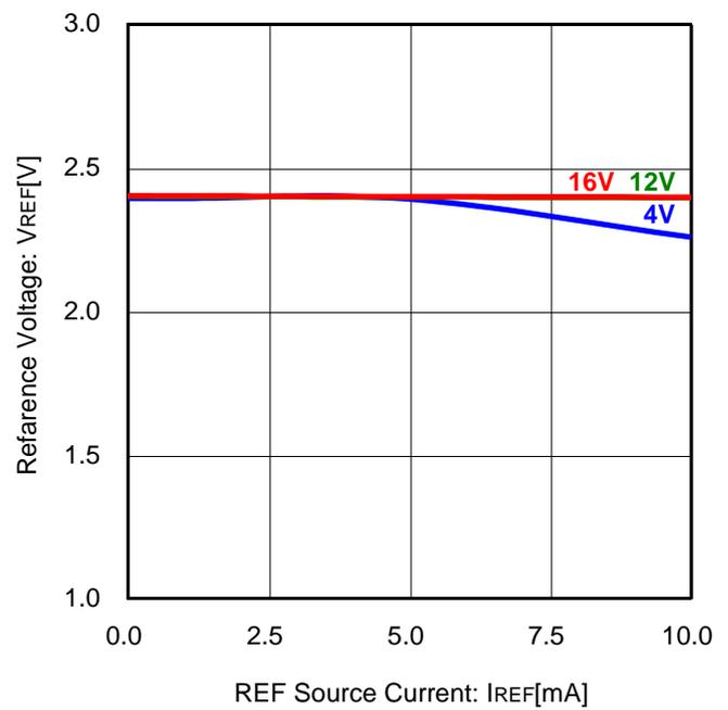
Figure 18. 基準電圧 vs REF 流出電流 (T<sub>a</sub>=25°C)
