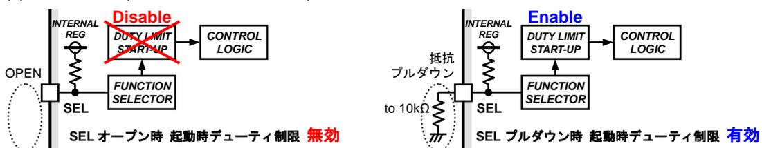
Figure 57. DC 電圧入力アプリケーションにおける信号選択
