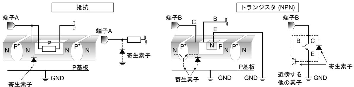
Figure 13. モノリシック IC 構造例
