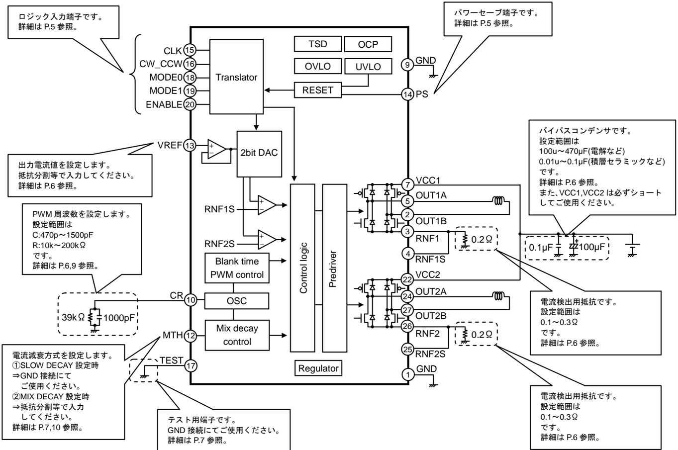
Figure 8. BD63720AEFV ブロック図・応用回路図
