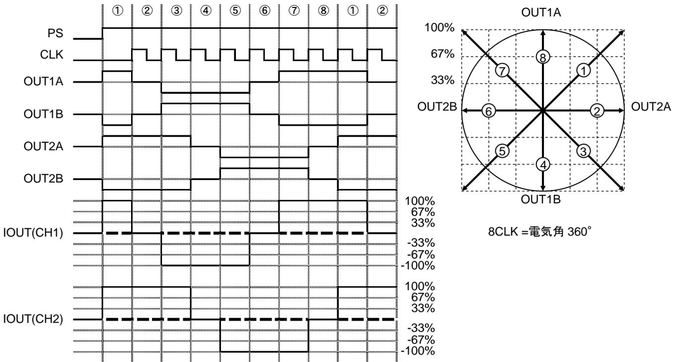
• HALF STEP B(MODE0=L, MODE1=H, CW\_CCW=L, ENABLE=H)
