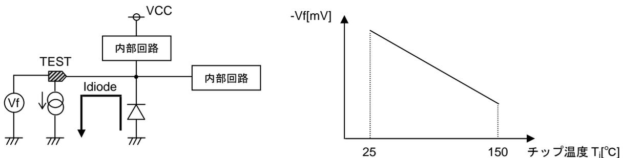
Figure 7. チップ温度測定の模式図
