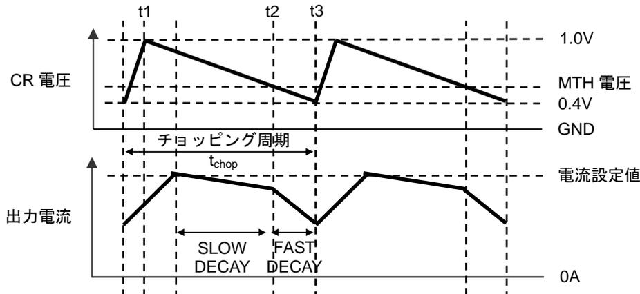
Figure 6. MIX DECAY 時の CR 電圧, 出力電流
