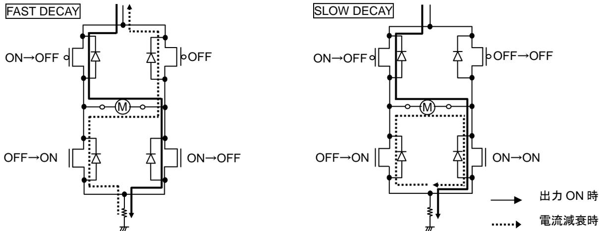
Figur 5. 電流減衰時の回生電流経路
