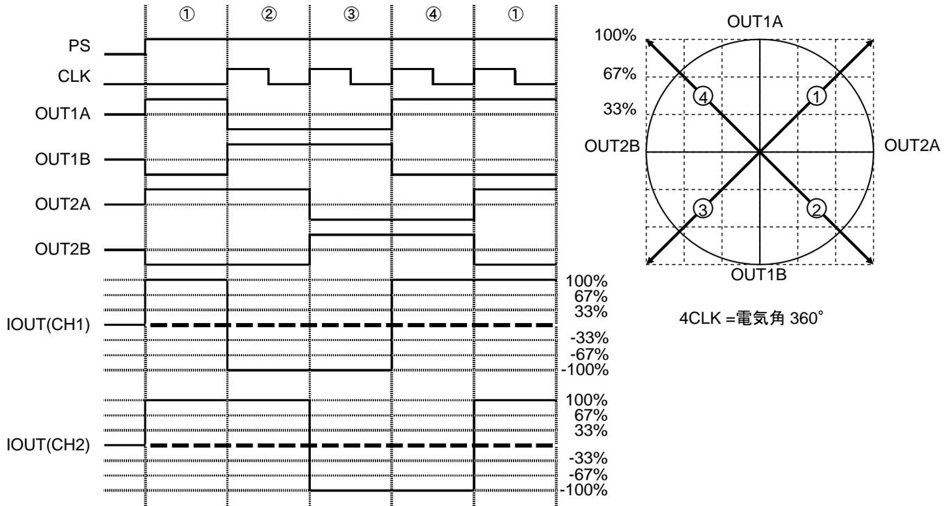
• HALF STEP A (MODE0=H, MODE1=L, CW\_CCW=L, ENABLE=H)
