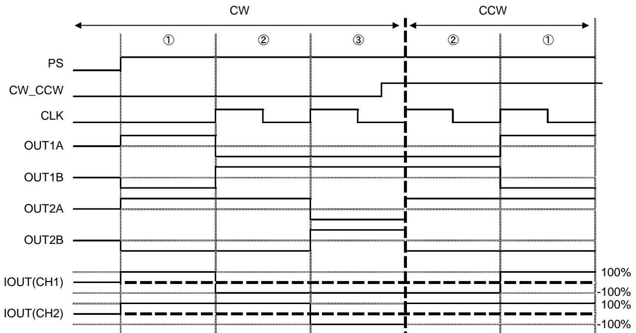
・ ENABLE 切り換えタイミングチャート(FULL STEP, MODE0=L, MODE1=L)
