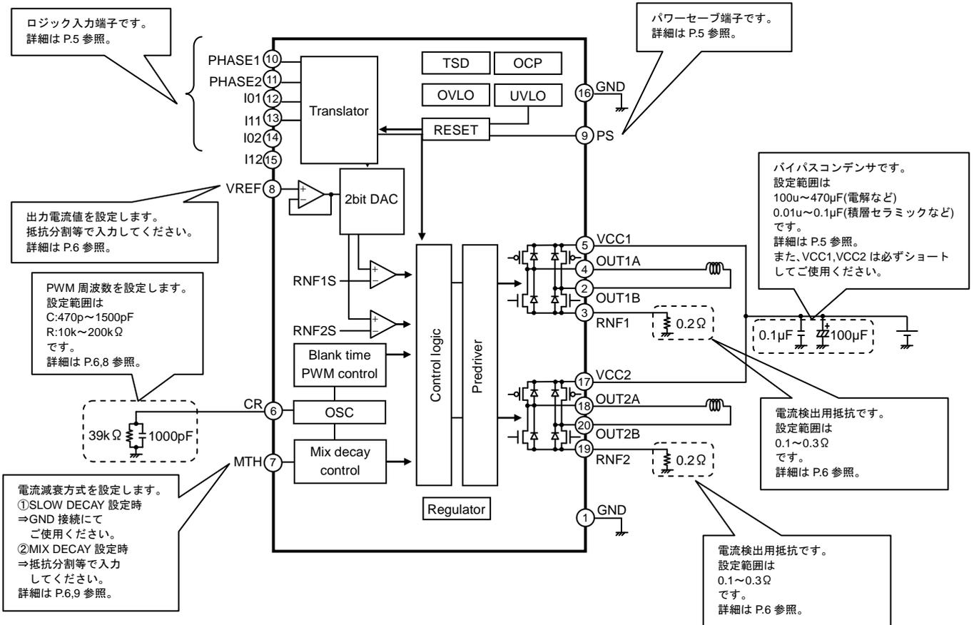
Figure 8. BD68610EFV ブロック図・応用回路図
