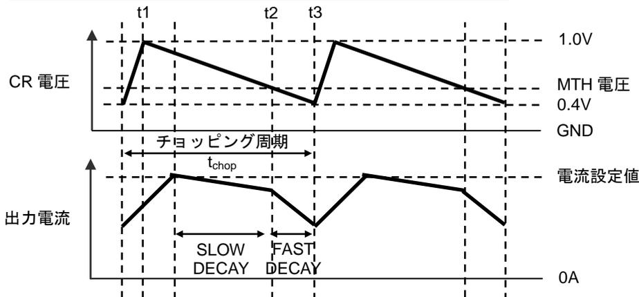
Figure 6. MIX DECAY 時の CR 電圧, 出力電流
