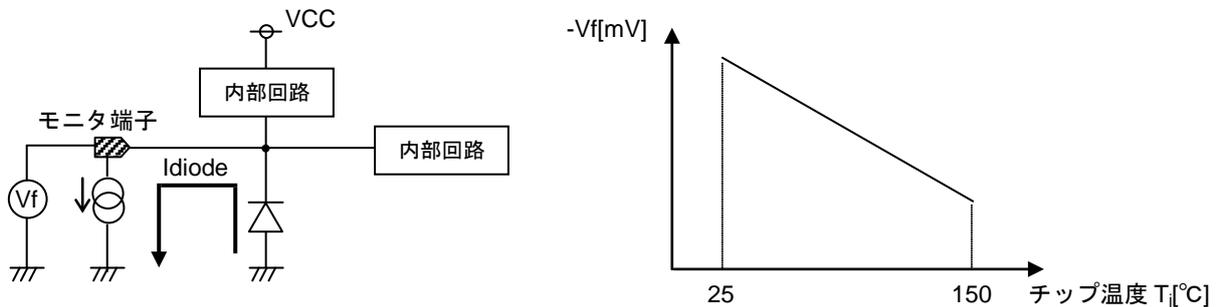
Figure 7. チップ温度測定の模式図
