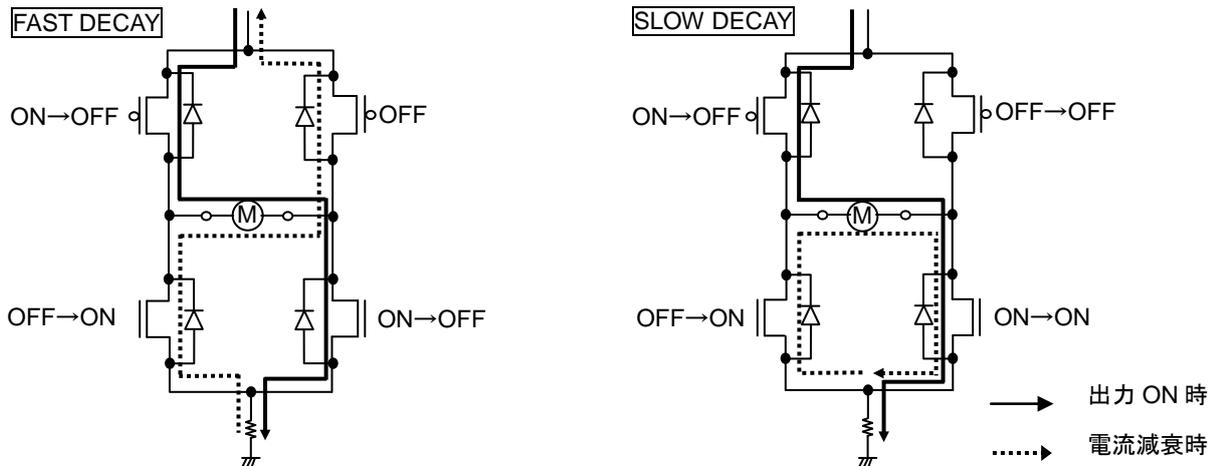
Figure 5. 電流減衰時の回生電流経路
