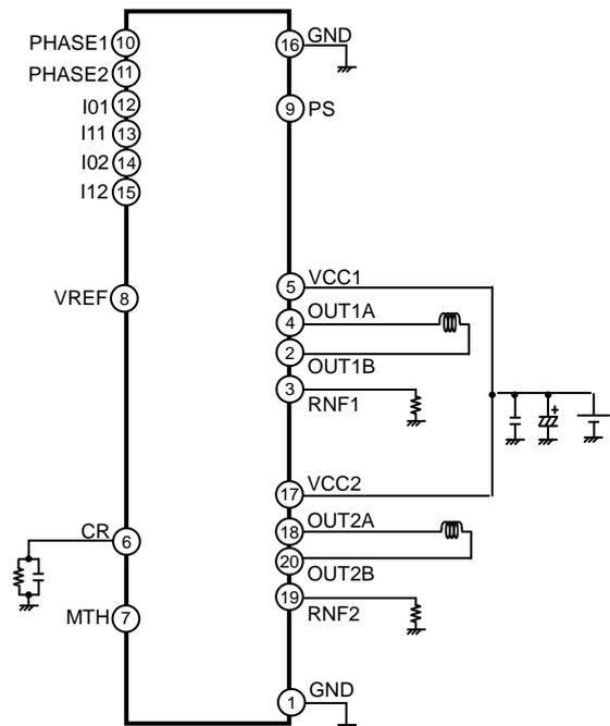
Figure 1. BD68610EFV アプリケーション回路図
