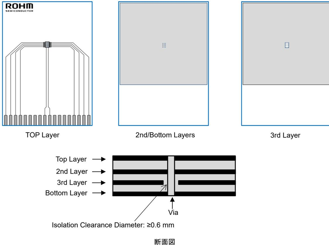
Figure 4. PCB レイアウト 4層 (2s2p)
