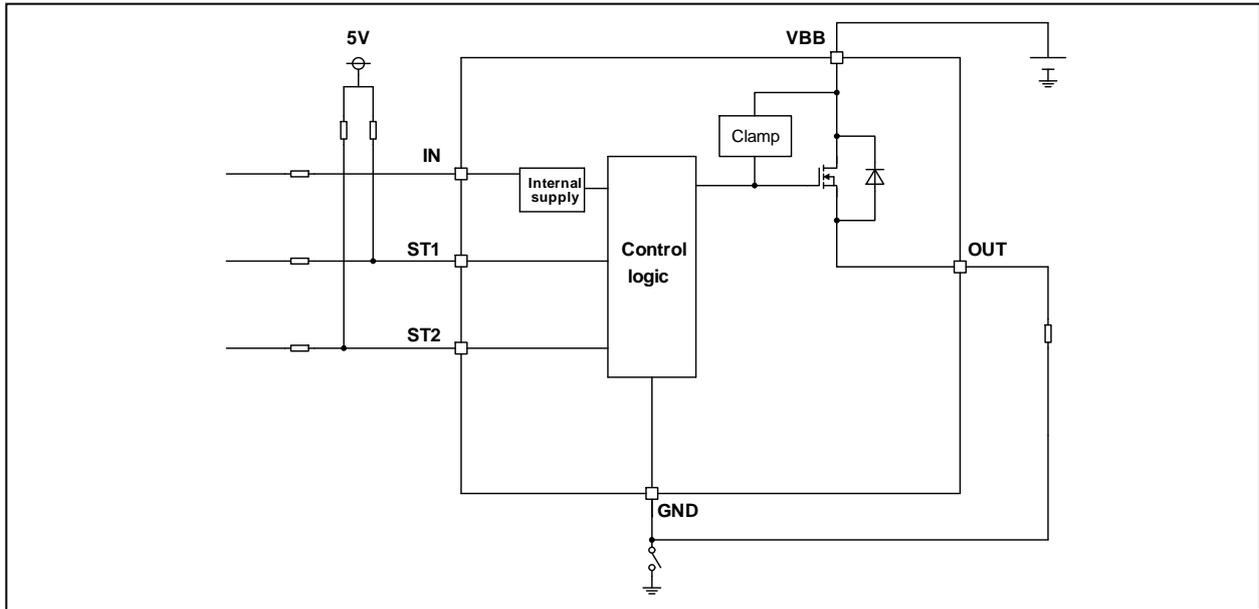
Figure 37. GND オープン保護 ブロック図
