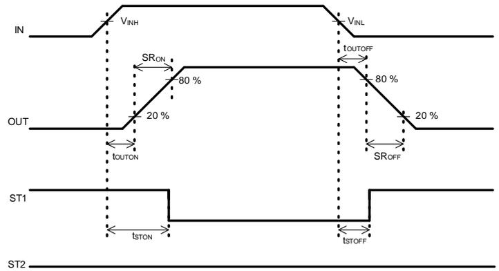
Figure 33. スイッチングタイム測定波形
