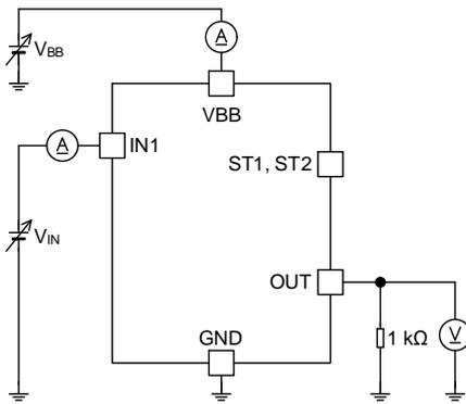
Figure 27. 低電圧時出力 OFF 検出電圧
