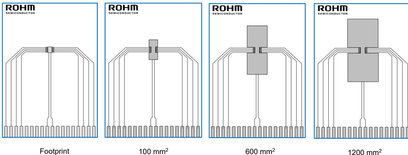
Figure 2. PCB レイアウト 1層 (1s)
