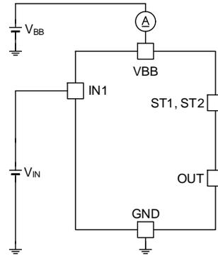
Figure 26. 動作時電流
