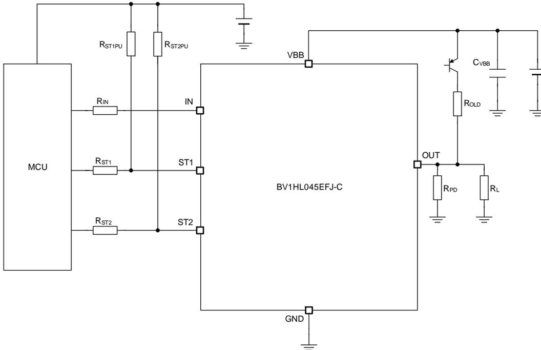
Figure 40. 応用回路図
