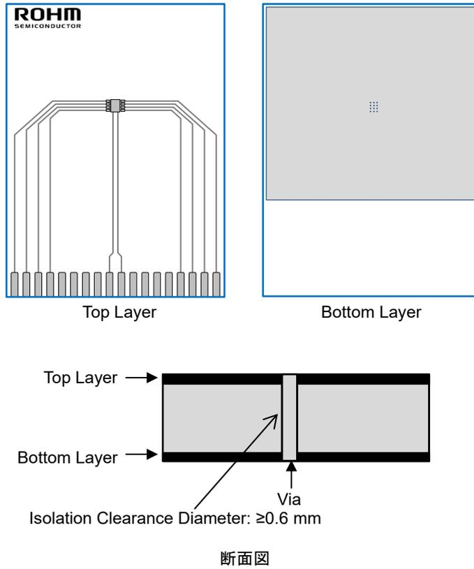
Figure 3. PCB レイアウト 2 層 (2s)
