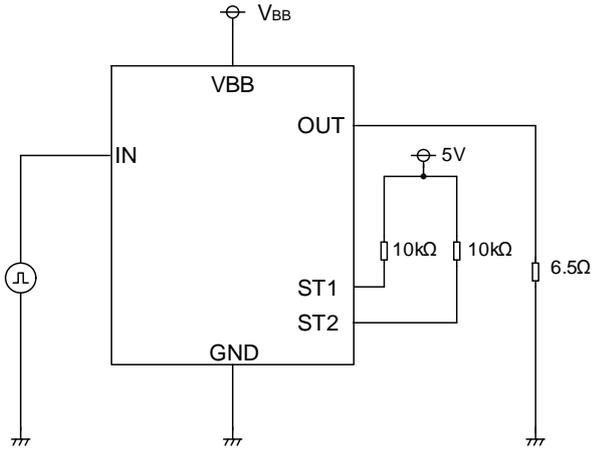
Figure 32. スイッチングタイム測定図
