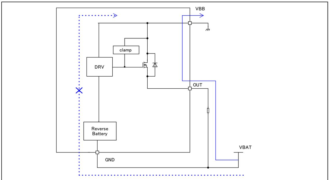
Figure 38. バッテリー逆接続 ブロック図
