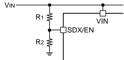
VIN端子立ち下り時のディセーブル電圧は次式で設定できます。
