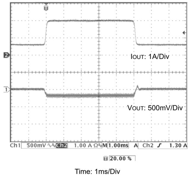
Figure 9. 負荷応答特性 (24V 入力、5V 出力、負荷補償なし、IOUT=600mA<->2A)
