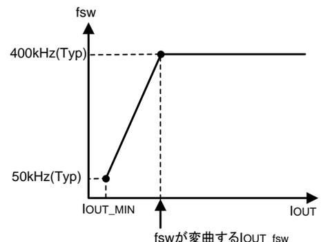
Figure 22. Switching周波数 対 負荷電流 イメージ
