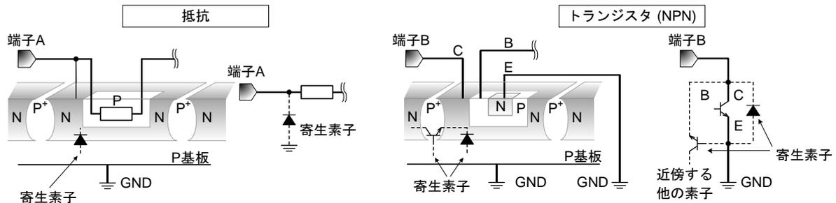
Figure 27. モノリシック IC 構造例
