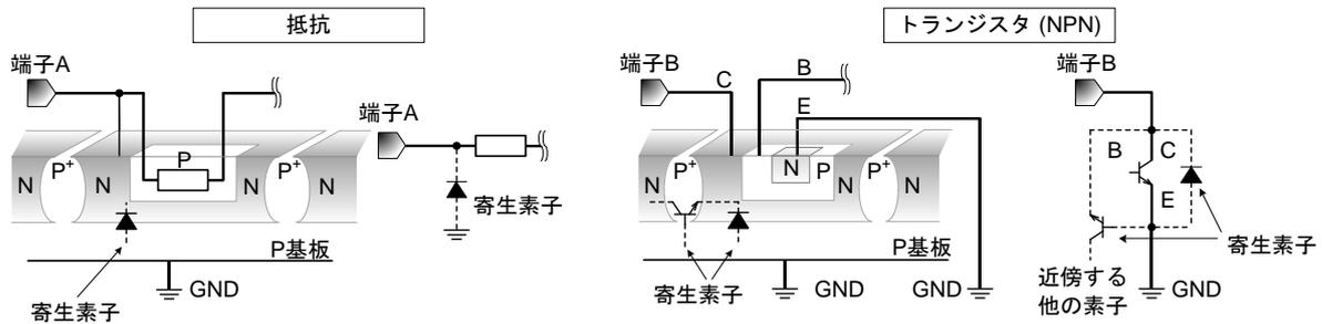
Figure 25. IC 構造例
