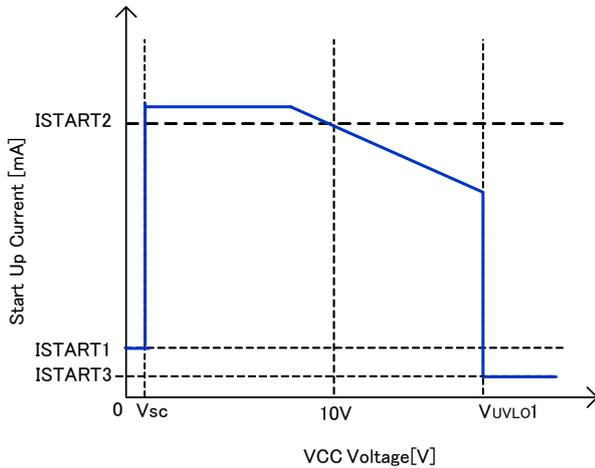
Figure 5. 起動電流 vs VCC 電圧
