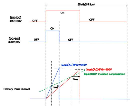
Figure 13. AC 電圧補正機能ありの場合
