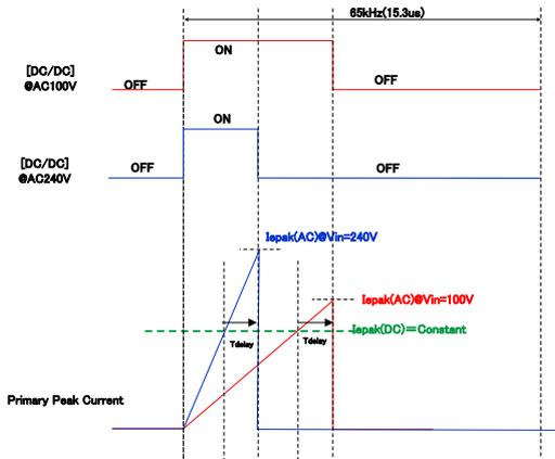
Figure 12. AC 電圧補正機能なしの場合
