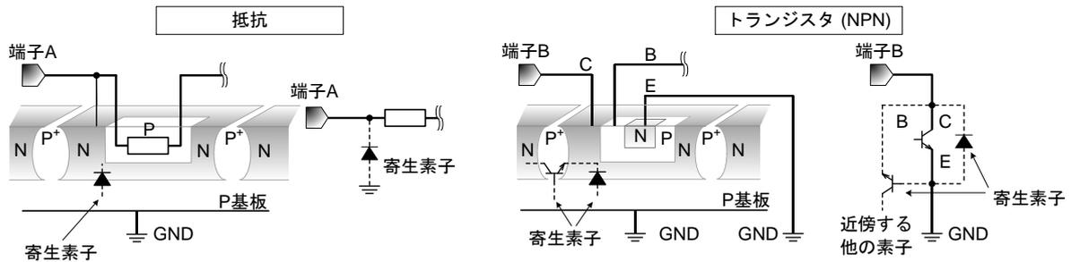
Figure 37. IC 構造例
