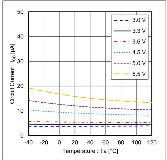
Figure 6. Circuit Current vs Temperature (シリアルデータ入力時)
