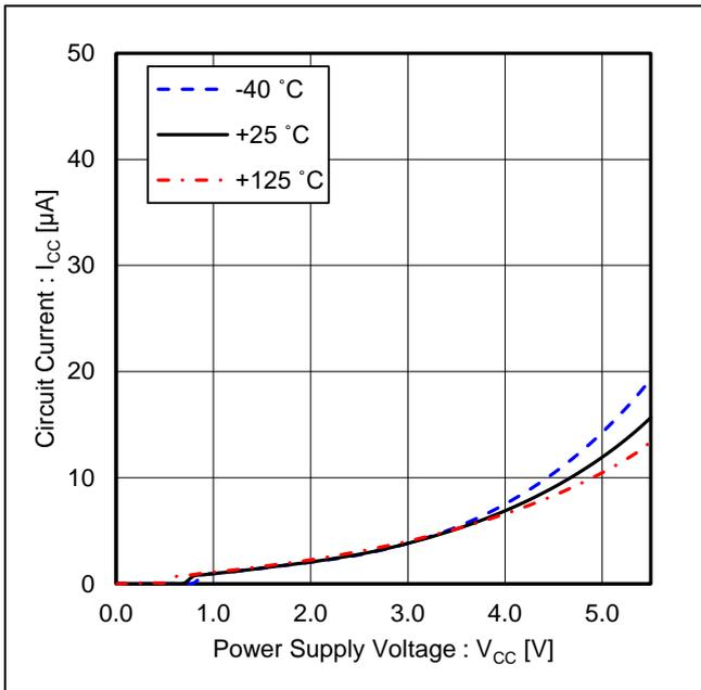
Figure 5. Circuit Current vs Power Supply Voltage (シリアルデータ入力時)
