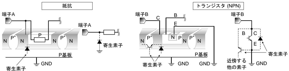
Figure 16. モノリシック IC 構造例
