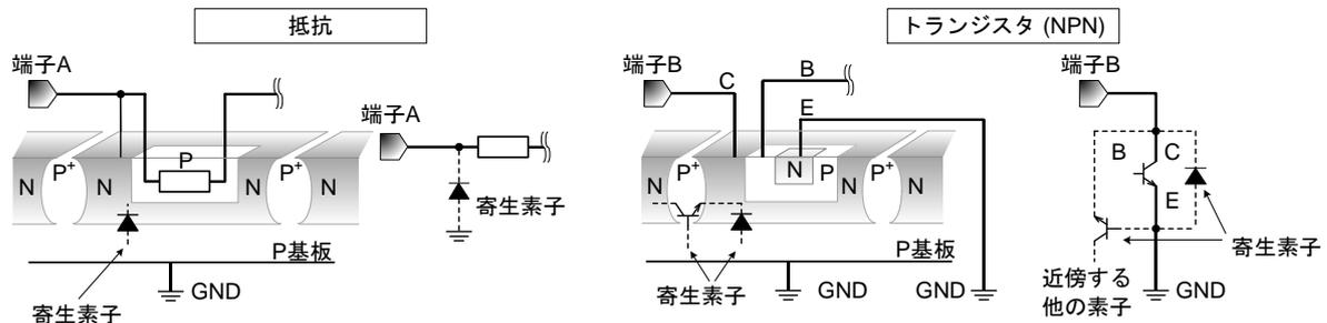
Figure 11. モノリシック IC 構造例
