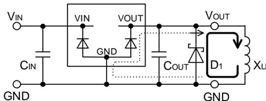
Figure 70. 誘導性負荷の電流経路 (出力 OFF 時)
