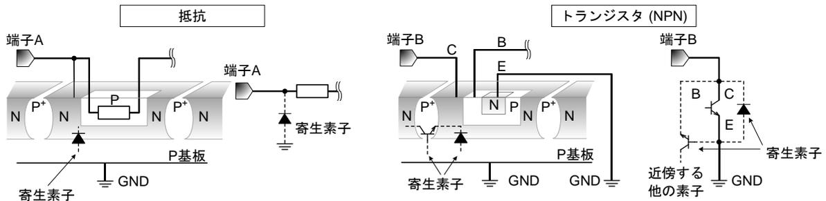
Figure 72. モノリシック IC 構造例
