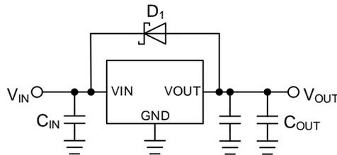
Figure 64. 逆電流バイパスダイオード
