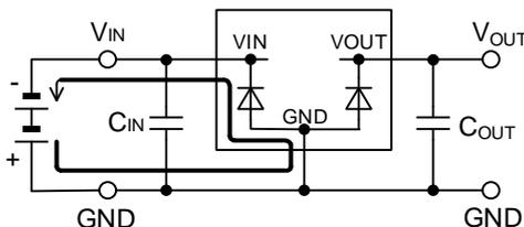
Figure 66. 入力を逆接続したときの電流経路
