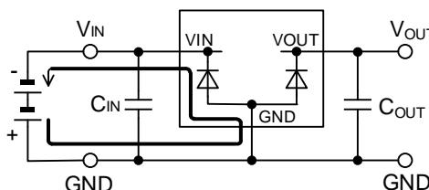
Figure 61. 入力を逆接続したときの電流経路
