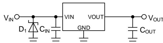
Figure 56. 入力に 45 V を超えるサージが印加される場合
