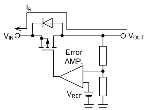
Figure 58. MOS 型の逆電流経路
