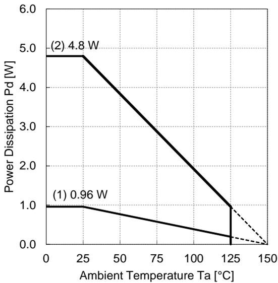
Figure 66. 熱低減曲線グラフ (HTSOP-J8)
