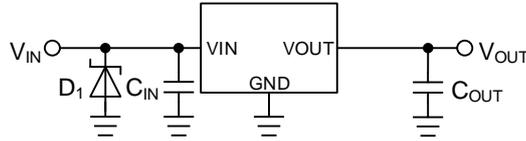
Figure 56. 入力に 45 V を超えるサージが印加される場合
