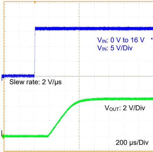
Figure 27. VIN Startup Waveform
