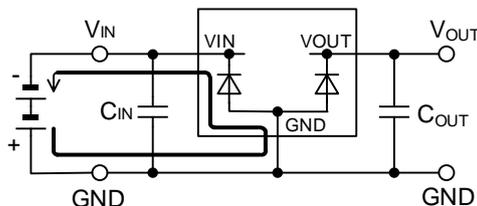
Figure 61. 入力を逆接続したときの電流経路
