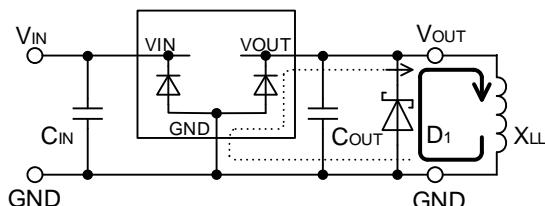
Figure 65. 誘導性負荷の電流経路 (出力 OFF 時)
