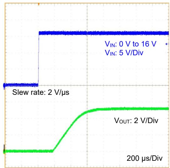
Figure 28. VIN Startup Waveform
