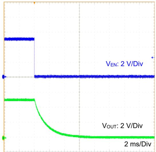
Figure 30. EN Shutdown Waveform
