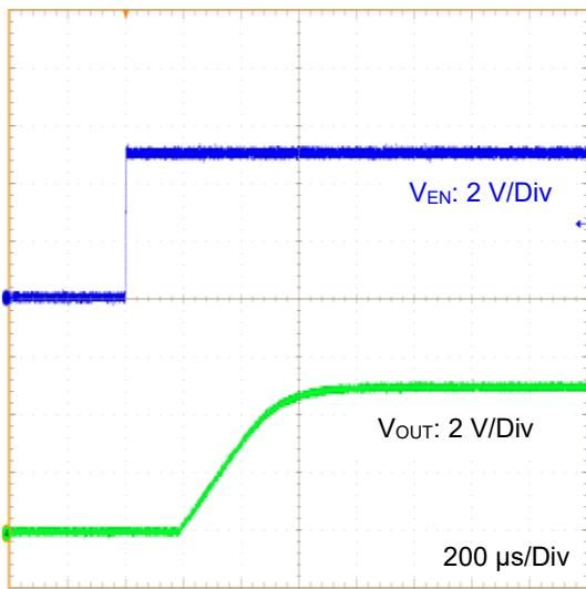
Figure 29. EN Startup Waveform
