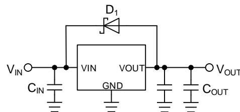
Figure 59. 逆電流バイパスダイオード
