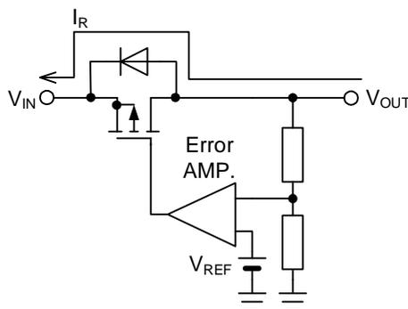
Figure 58. MOS 型の逆電流経路
