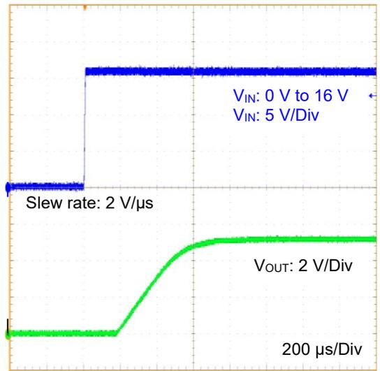
Figure 28. VIN Startup Waveform
