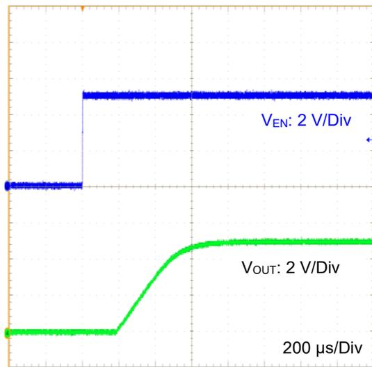
Figure 29. EN Startup Waveform
