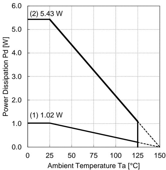
Figure 67. 熱低減曲線グラフ (TO252-3 / TO252-5)
