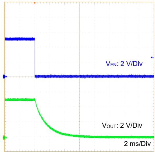
Figure 30. EN Shutdown Waveform
