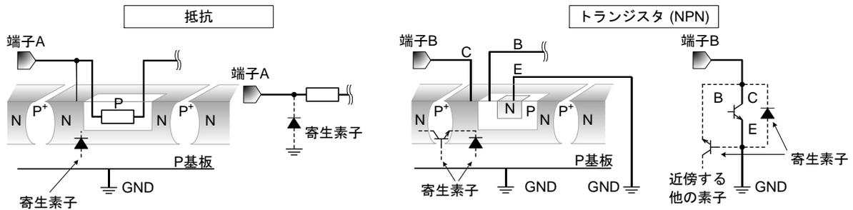
Figure 68. モノリシック IC 構造例
