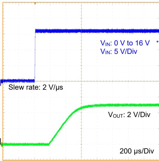
Figure 27. VIN Startup Waveform
