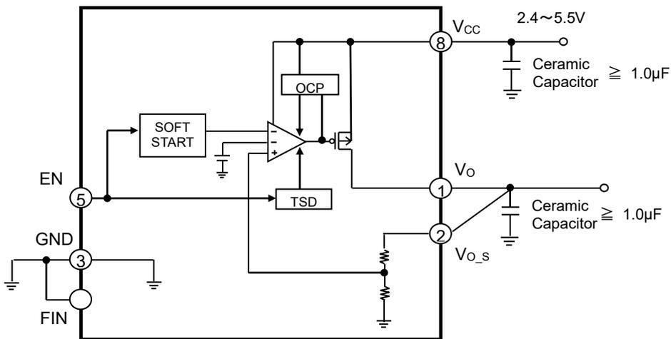
Fig.2 ブロック図 (固定出力タイプ)
