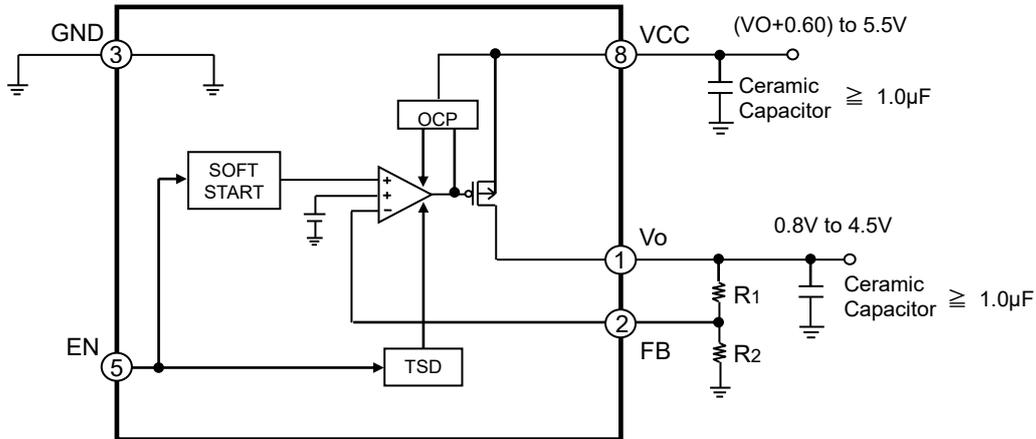
Fig.1 ブロック図 (可変出力タイプ)
