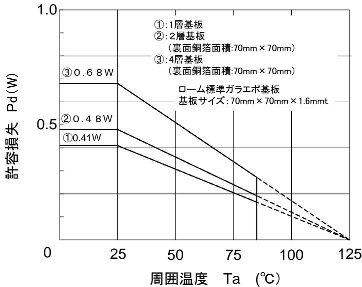
Fig.180 HVSO5 許容損失熱軽減特性(参考)
