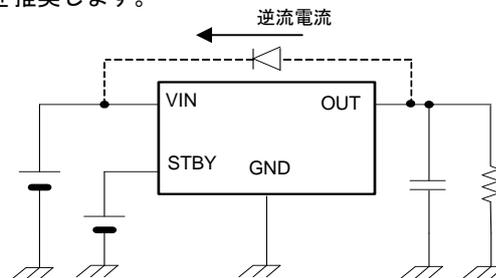
Fig.181 バイパスダイオード接続例
