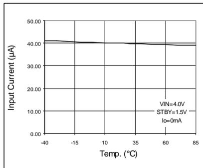
Fig. 131 IIGND vs Temp
