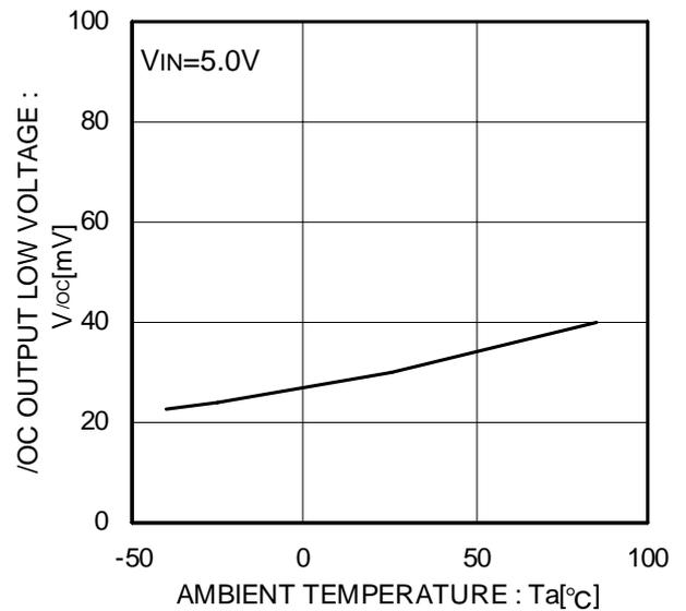
Figure 15. /OC 出力 Low 電圧
