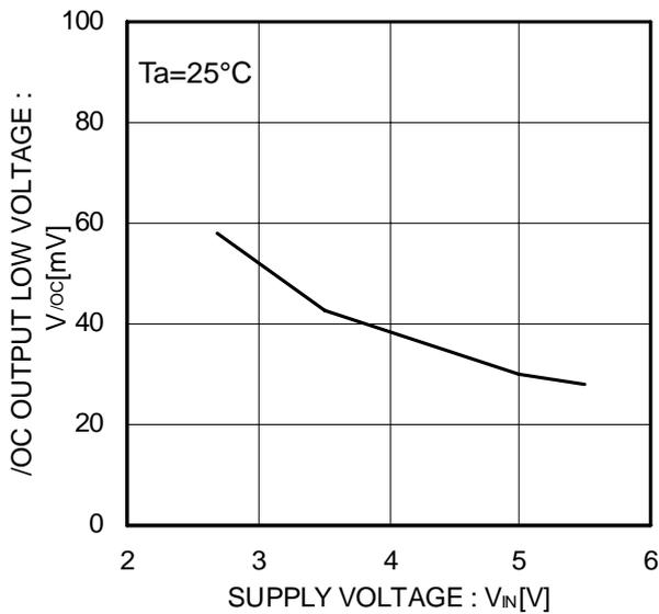
Figure 14. /OC 出力 Low 電圧
