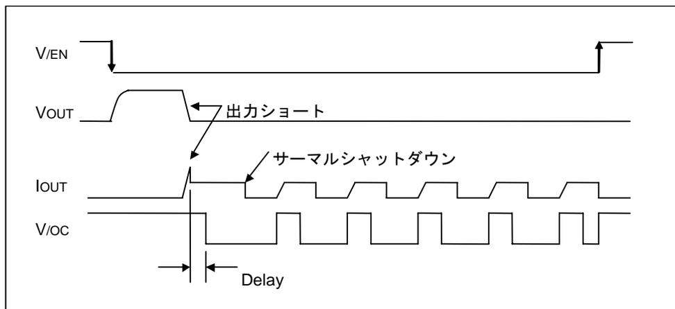
Figure 39. 過電流検出、サーマルシャットダウンタイミング (BD2227G)
