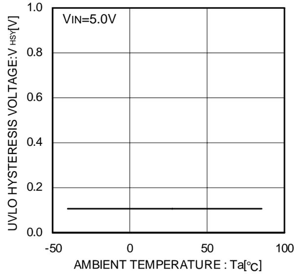
Figure 17. UVLO ヒステリシス電圧
