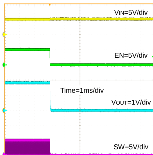
Figure 29. シャットダウン波形 (EN = 5V → 0V)
